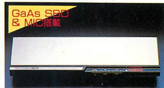
**新発売 定価56,000円** 仕様 電源電圧 DC12V(24Vアダプター 別売) 消費電流 静止時120mA、作動時 MAX200mA ■受信周波数 Xバンド(10.52GHz) ■作動温度範囲 -20℃ ~ +80℃ (-4°F ~ +176°F) ■アンテナホーン型特徴 設計アンテナ ■受信回路 スーパーヘテロダイオ方式 ■使用半導体 SBDカラムヒュミ素子タイプ (GaAs Schottky-Barrier Diodes) ■サイズ 273(W) × 30(D) × 78(H) mm
