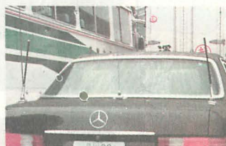
警視庁のベンツの警護車。左に自動車電話形基幹系用150MHz、中央に日本アンテナ150MHzトランクリッド、右側にNTT官公庁向け自動車電話アンテナ。
