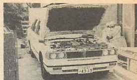
エンジンは VG30f 型、出力グロス 180ps/5200rpm、トルク 26.5kgm/4000rpm のパワー、トルクを発揮。1390kg のボディを 5 速マニュアルミッションで引張れば、そのへんのスポーティカー顔負けの加速力を持つ。
