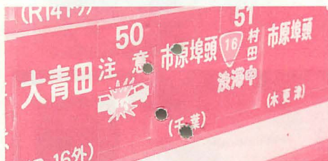
▲可変標識表示板。16号線外回り大青田の可変標識が「事故注意」の表示を示していることがわかる。ちなみに市原埠頭千葉の標識は「16号村田方面渋滞中」を示しているというわけだ。
