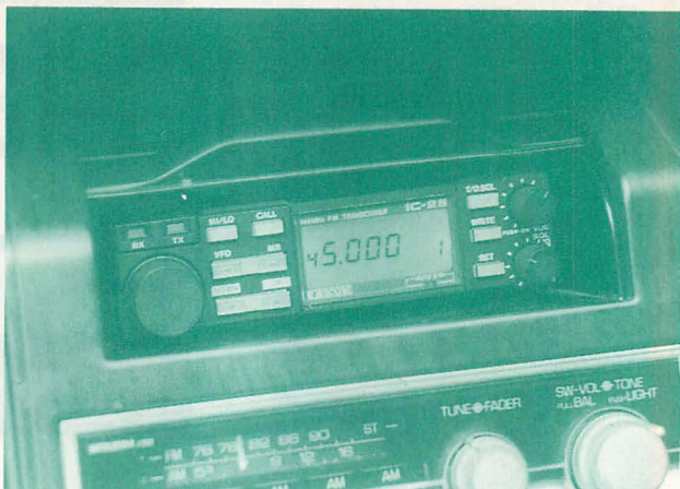
IC-28をコンソール内にセット。MICコネクタがないのでスッキリする
