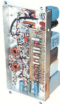
F) AF ユニット底面 過去、100台近いR-390Aの修理の中で、最も故障が多かったコリンズの設計ミス。ラグ板の中央のタンタルコンデンサー。AFユニットの電圧増巾部のカソードのバスコンの熱破壊によりノイズ。これは無い方が電流帰還が掛り良い、利得は充分ある。
