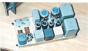
E) AF ユニット 各々はコネクターとネジ4本で簡単にバラせる。電解コンデンサーの手前が切味抜群 CW 用オーディオフィルター。
