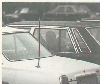
警視庁××部の覆面バトカー (旧形クラウン) 基幹系用にアンテナのスプリングエレメントとパーソナル用ハッチバック基台を使用。
