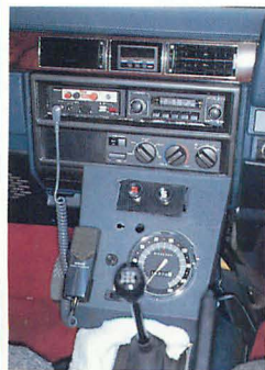
◀コンソール付近拡大。ラジオ横にサイレンアンブ、センターコンソールに速度測定用スピードメーター、サイレンメインスイッチ、回転灯スイッチがある。なお、このセンターコンソールボードは本物の PC から借用した。
