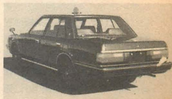
トヨタクラウン覆面パトカー。反転式回転灯を出した状態。
