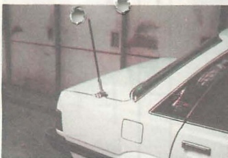
写真2 アンテナ外観。取付け位置も、外観も、NTT 自動車電話と変わらない。メーカーは、従来通り××××で、150MHz 基幹系専用アンテナと、移動警電・基幹系のデュアルバンド (350/150MHz) アンテナの2種類がある。
