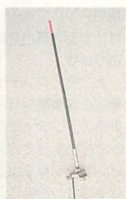
アンテナ移動警電用トランクリッド。パーソナル用も同形
