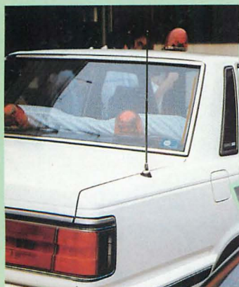
◀某隊の覆面 PC から借りてきた FI ホイップを取付けた (150MHz 帯用)。後部トレーの上に回転燈が、2 台載っているが、神奈川県警・交通取締用覆面 PC は天井の反転式回転燈と合せて、3 台搭載している。
