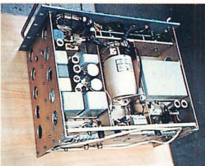
D) 底面 中央の円筒形が2重シールドされたオープン入りのVFO。右は密閉型の電源トランス、左はAFユニットで、オーディオフィルターやブレイクインリレー及びスピーカーを鳴らしながら有線や録音に使用出来るVUメーター付の2系統のアンプが載っている。
