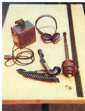
I) 付属品の一部、左は防水スピーカーLS-160/u。中央上はヘッドフォン。その下はハンドセットH-33。右はジープ用アンテナセットAB-15。エレメントの組合せで1m~3m以上にできる。この他、リモートコントロール器等豊富なアクセサリーがある。
