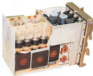
G) 正面の真空管はバラスト管（バラスト管は真空ではなく、水素が入っています）。計6本とスタビロ（定電圧放電管）2本、整流管2本とGT管の形をした過電圧リレー2本でできている。
