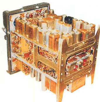
D) 本体後部のフレームを取ると、送受のシャーシーに分離することができる。色が黄色いのは防湿、防錆のMFPのため。
