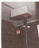
反転式警光灯はルーフ中央部収納式(上)ルーフ中央部の車内(下)。
