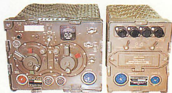
B) 左が本体 RT-68。右は電源 PP-112。放熱と耐衝撃性向上のため、ケースは波板の2重構造になっている。
