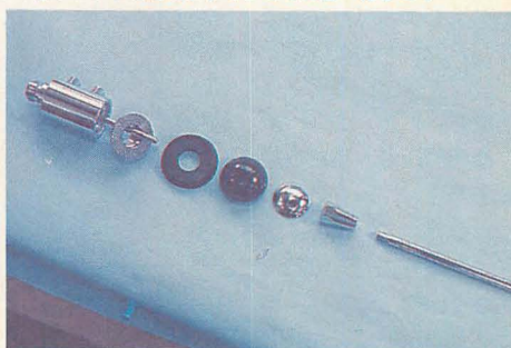
内部のホットは中心部を貫き樹脂でフローティング
