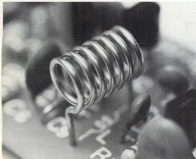
コイルの巻き直して、自由に周波数を変えることができる。周波数の調整もこの コイル。
