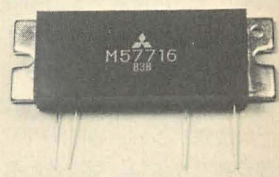
144MHz用のM57716、ちょっとした改造で80MHz用になってしまう。
