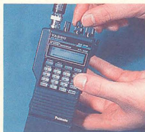
FT-728のコマンドによる受信改造。アップキーとダウンキーを押しながら電源スイッチ ON。
