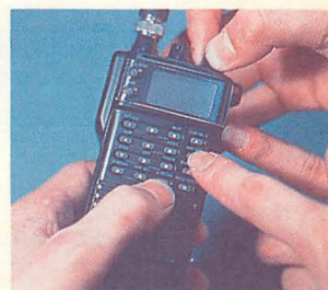
IC-24のコマンドによる受信改造。ライトスイッチと#とBボタンを押しながら電源スイッチ ON。ひとりじゃ操作できません！
