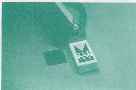
▲消費電流は1A程度に達するので、アルカリ乾電池かNi-Cd電池が必要です。
