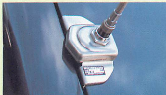
▲149.71MHzにマッチングされたアンテナ。
