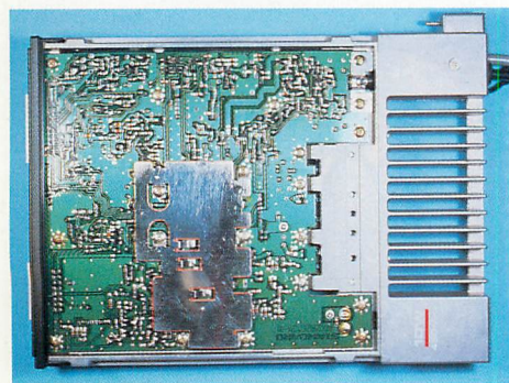
▲写真19 UHF ユニットの底蓋を開けたところです。基板そのものは、一枚です。
