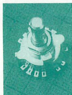
▲写真11 ロータリースイッチ 2回路6接点。周波数レンジの切替と電源スイッチに使うのだ。
