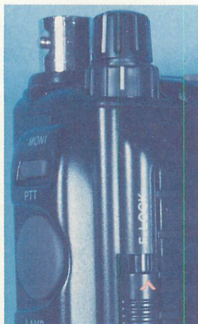
▲写真2 PTTスイッチのすぐ近くにあるので、F. LOCKのオン/オフはすばやく簡単に操作できます。
