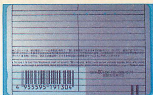
▲写真3 テレカは全面が磁性体になっているので、ワークチップは1枚から26枚できる計算になります。
