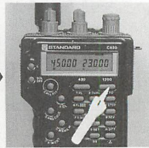
▲写真4 / クロスバンドリピータの解除は、「430」か「1200」を押します。
