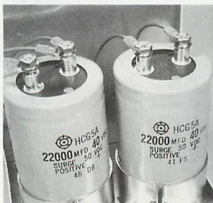
▲電解コンデンサの並列。電源の平滑回路などで、よく使う手です。
