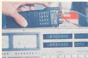
▲改造後のテスト。出力は最大40m W 程度でした。
