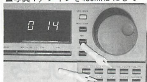
▲写真3 / 「FUNC」+「MW」を押す。
