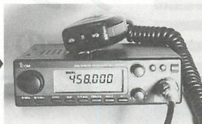
▲写真3 / 表示の変化はほとんどない。解除は、「BAND」キー+「SET」キーを1秒以上押す。
