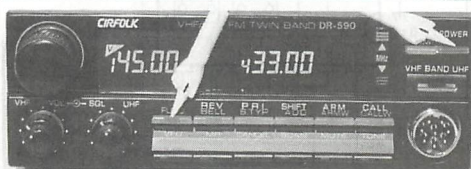
▲写真9 / ハード改造のあとはリセット! リセットは「FUNC」+Power ON
