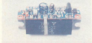
▲UHFのモジュールユニットを取外します。
