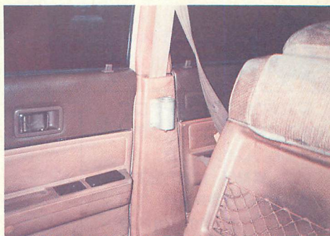
▲赤色回転警光灯用のシガーソケットはピラーの中央に取付け。コードはドアの隙間から引込む。
