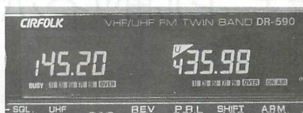
▲写真6 / クロスバンドリピータ動作中。U・Vの表示が約3秒ごとに入れかわる。
