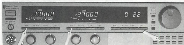
▲写真14 / クロスバンドレピータは、まず周波数を設定して、「FUNC」を押しながら、クロスバンドレピータさ瀬るバンドの「MAIN」(2つ)を押す。表示部のFマークが消えたらセット完了。
