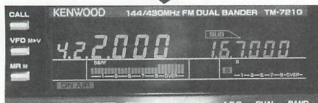
▲写真3 / レピータ動作中! なんと、3分以上の連続送信はしないようにタイマが内蔵されています。本物のレピータ局そっくりなうれしい機能です。この機能のおかげでレピータのひとりじめはありません。
