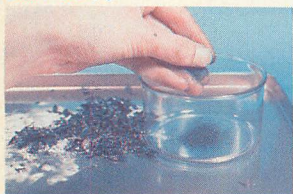
▲写真3 燃えカスを指でもみほぐして、微粉末にします。細かいほどいい！
