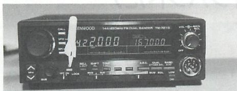
▲写真1 / UHF・VHF 共に周波数を設定したら、まず、「F」を押します。
