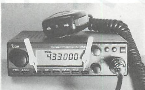
▲写真2 / 次に、「BAND」キー+「SET」キーを1秒以上押す。
