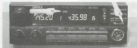
▲写真8 / 「FUNC」の点灯中に「UHF」を押す。U・V表示が入れかわると「FUNC」が消えてしまうので注意!
