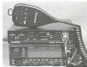
▶写真14 トランシーバのマイクコネクタに接続して使います。これで秘話通信ができてしまうのです。
