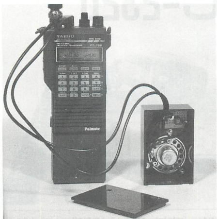
▲写真1 / クロスバンドリピータ動作中。製作したユニットのスピーカでモニタできて、とっても便利です!
