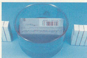
▲写真6 テレカを浸して、少し攪拌してしばらく待ちます。この時点でデータが見えてきます。ゆっくり引き上げて灯油を揮発させます。
