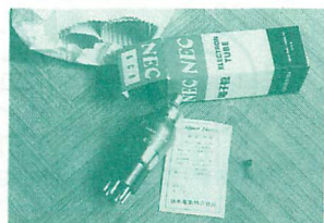
▲0-V-1用6C6。5 極管の頭の角は送信管とちがいが、グリッド(G1)が出ている。（写真6）
