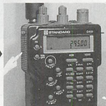
▲写真4 / PTTを押して、で上がり。「FUNC」+「3」でバンドが変わり、350MHz帯が受信できます。
