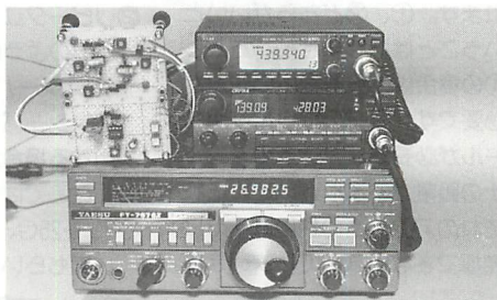
▲写真3 このユニットさえあれば、HFとV・UHFのクロスバンド運用ができる!
