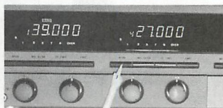
▲写真15 / 解除は、どちらかのバンドの「MAIN」を押す。
