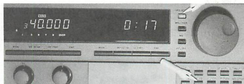
▲写真6・7 / 「FUNC」+「VFO/STEP」を押す度に、バンドが切替わり、350MHz帯・800~900MHz帯が受信できる。
