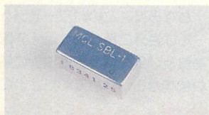
▲ジャンクで購入した DBM。新品でも1000MHz 程度のものなら入手可能です。
