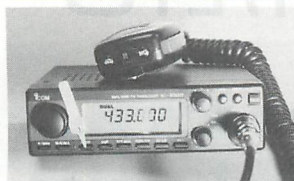
▲写真1 / U・V 共に周波数を設定して、「BAND」キーを1秒以上押す。
