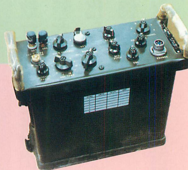
写真1 全景。ボディー横の白い部分に1~6chの送受信周波数とアンテナ・チューニングの目盛りを書き込んでおく。
