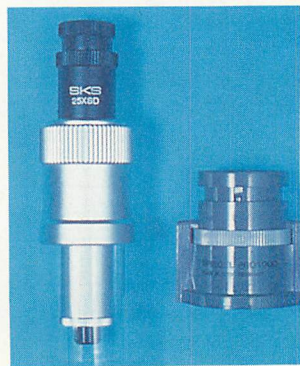
▲写真1 左が倍率25倍のマイクロスコープ。右が倍率10倍のルーペ。
