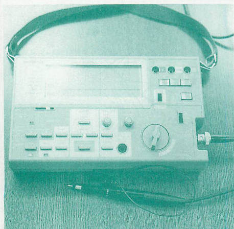
▲ブラウン管ではなく、LCDを採用したポータブルオシロスコープ。波形メモリーもできます。
