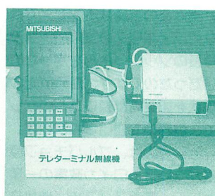
三菱のテレターミナルシステムの無線機と端末。業務用パケット通信が可能。
