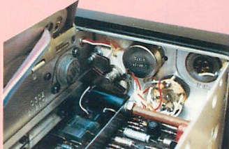
写真11 AVR トランジスタ 2N297A の右側のタイトバリコンは BFO ピッチコントロール、その手前の黒い円筒は BFO 発振用コイル、右上のオーディオコネクタ（金メッキの 5 ピン）に注目。
