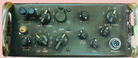
写真2 フロントパネル。送信6ch、受信6chは、個別に設定できる。左端のチューニング・インジケータは本文参照。
