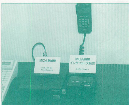
MCA用リモコン装置。ビジネスホンからMCAにアクセスできる装置。個別呼出も出来、着信も可能。
