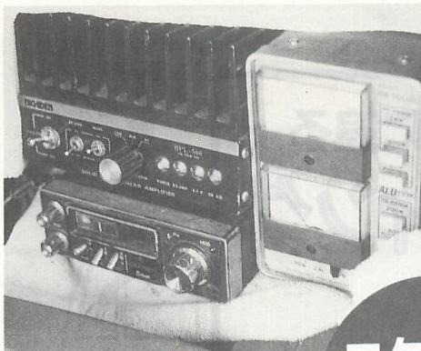
▲この局は12V用のアンプを使っている ので、CB機+アンプを片方のバッテ リで賄う。あまり良くない使い方例。
