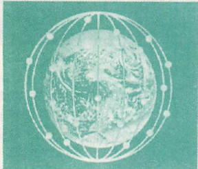
米モトローラは此軌道に77個の小型衛星を打ち上げ世界を周回する衛星網「イリジウム構想」を推進中だ。
