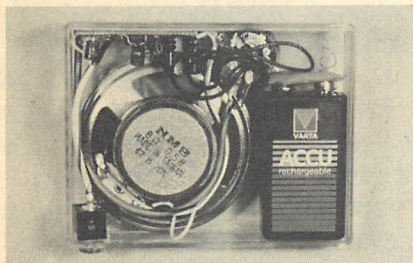
▲386アンプをプラスチックケースにセットしました。プラスチックケースは、加工が簡単で良いのですが、見晴えが悪いので、アルミケースの方がいいかも。
