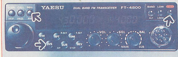
▲写真4 ハードでの改造が終了したら、MHzキーとDVSキーを押しながら電源オフの状態から、電源オンにします。この動作をもう一度繰り返すと、ノーマル状態のアマ機に戻ります。
