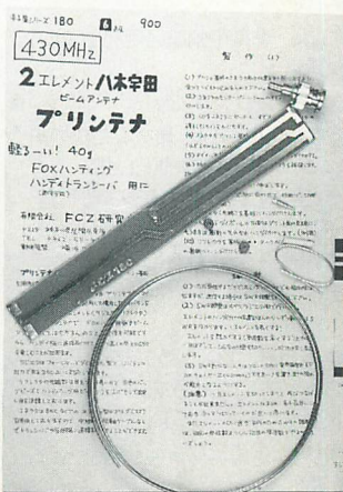
▲キットのマニュアルと部品です。部品といっても、専用基板とコネクタとエレメント材料だけです。
