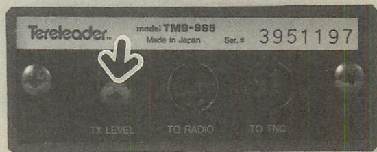
▲送信時の変調レベルは、TMB-965/961の背面にあるTX LEVELの半固定抵抗で調整します。
