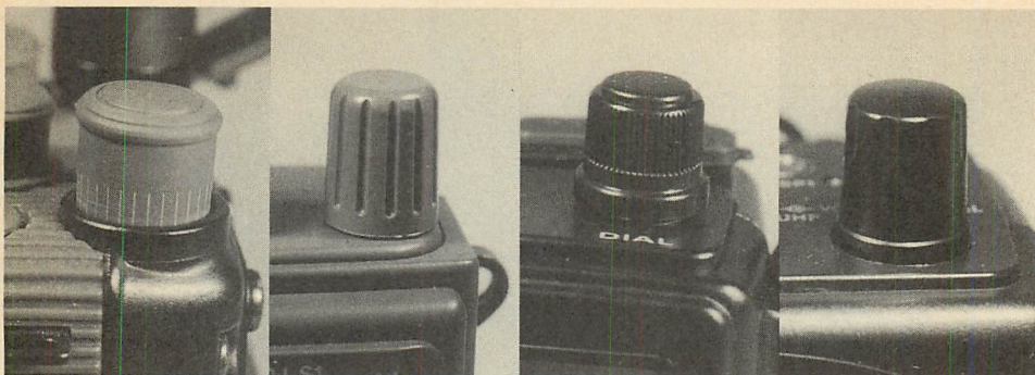
回転選局つまみの形状。某1社以外は、どのメーカーもスベリを減らすために、ゴム質つまみを使ったり、刻みを入れたりと奮闘している。(左から C160/460、DJ-S1、FT-74、IC-W2)
