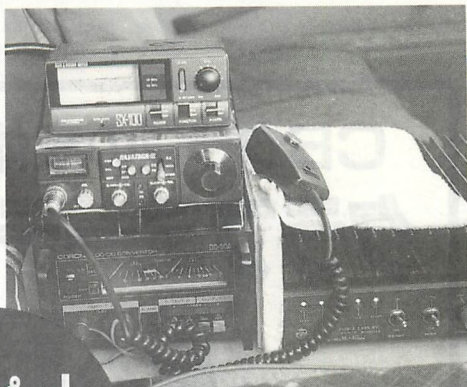
▲この局は、24V用アンプを使ってい るので、CB機用としてDC-DCコンバ ータを使っている。
