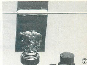
▲写真7 リフレクタは基板の裏のGND にべったりとハンダ付します。
