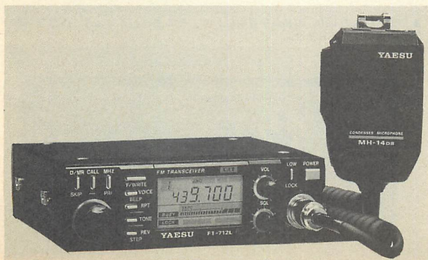
▲ TMB-965/961のマニュアルにはTF-712Lの改造方法しか紹介されていませんが、原理的にはどのトランシーバでも同じようなものです。
