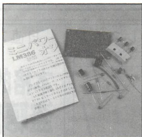
▲写真1 発振器は、秋月電子の386Aピンキットを使います。発振回路も入っているのです。
