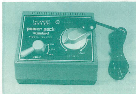
▲ごく基本的な構造だけで作られている市販のトラコン(関水金属製)
