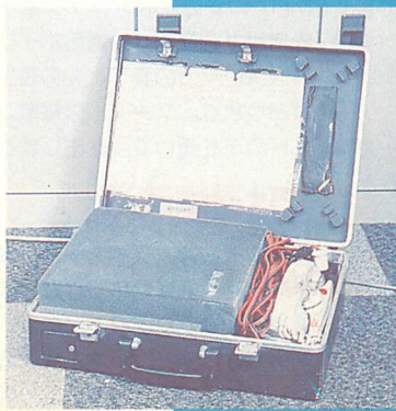
▲ハンドセットやダイヤル部分は、トラ クのなかに収納されるようにならている。
