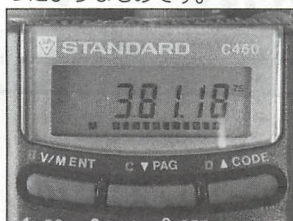
▲ガリヒ素プリアンプを入れたら、Sは振り切り、明瞭度もアップします。
