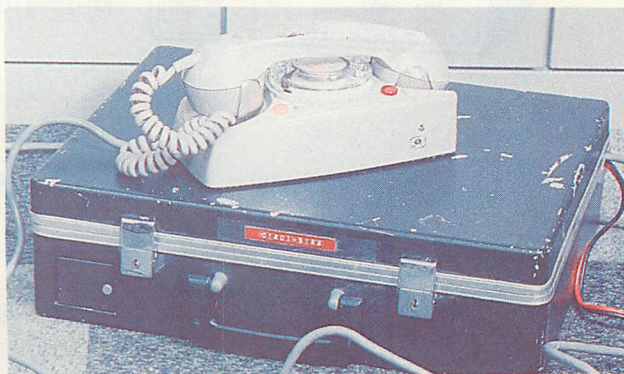
▲トランクの中に高周波部分や秘話部分が入っているのですが、使用するときにはフタをボタンと開けて使うことができます。
