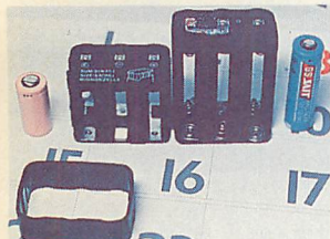
▲写真5/右はオリジナルのケースでカッティング後は、左のバッテリーケースのようになります。
