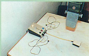
▲カフには録音室にいる人と調整卓にいる人とコミュニケーションをとるためのイヤホン端子が付いています。
