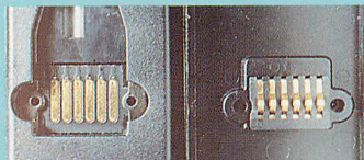
▲これは、本体とフロント部分をつなぐコネクタ。本体側は平らな接触面で、フロント側はスプリングになっていて、いずれも接点は金メッキ。脱着式がウリだけあって、この辺は感心・感心。
