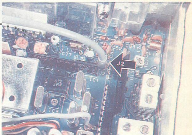
▲自動車電話帯などの受信には外部アンテナをこのようにJ2から引き出します。
