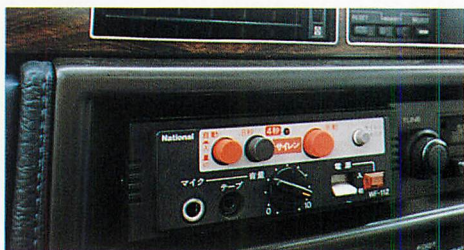
サイレンアンプは、松下製を装着。鳴らしながら走ってはいけません。コンソールに装着して、足元フットスイッチに接続。車内助手席には、無線搭載コンソール置針式ストップメータ、5速ミッションが恐ろしい！気分は完全に交通機動隊！
