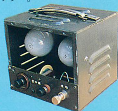
▲大昔からある究極のダミーロード。正規では75W 電球 2ヶ使用、明るすぎるので100W × 2 使用。
