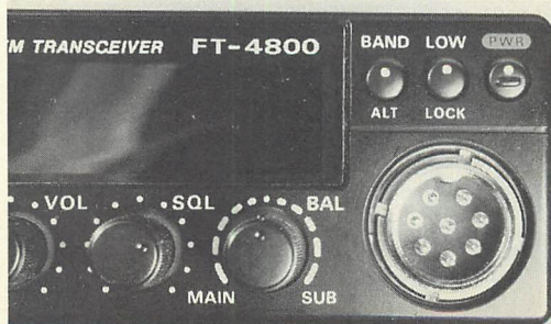
▲写真3 トランシーバを自動 QSY (周波数変更) するには、マイクコネクタから信号を送ってやればよいのです。
