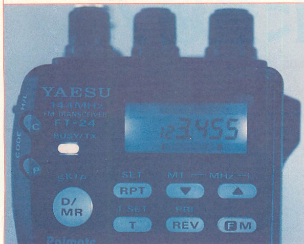
▲写真3 リード線をカットしたら、受信改造のコマンドを入力します。コマンドは、アップ[▲]キーとダウン[▼]キーを押しながら電源オフの状態から電源オンします。このコマンドをもう一度こなうと、ノーマルにもどります。
