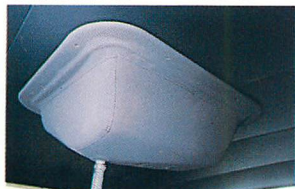
車検が取れなくなるので反転灯のカバーのみ装着した。パイプは水抜き。
