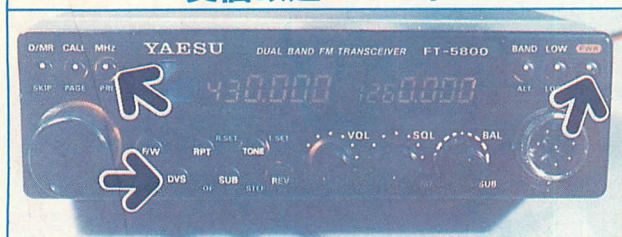
▲写真4 ハードでの改造が終了したら、MHzキーとDVSキーを押しながら電源オフの状態から、電源オンにします。この動作をもう一度繰り返すと、ノーマル状態のアマ機に戻ります。
