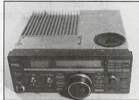
▲写真1 上フタを開けると、豪華なアルミダイキャスト製の PA ユニットがあります。
