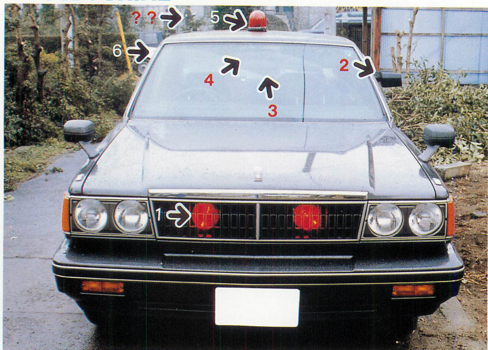
特別装備品外装備。1は前面赤色灯、2は助手席ミラー、3はダブルミラー、4は反転灯カバー、5は赤色回転灯、6はF-1アンテナ、??に本職が！
