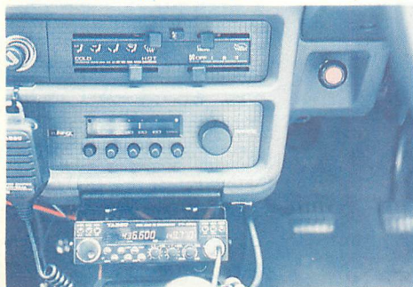
セパレートケーブルを使えば、軽いコントローラーはどこにでも貼れる。
