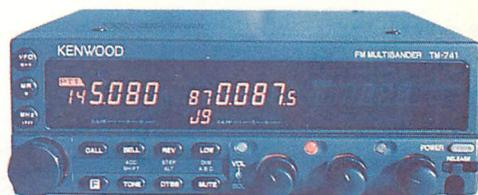
▲裏メモリ機能を使えば、各バンド100チャンネル毎のメモリが一挙に倍増し、各バンドで200チャンネル毎の合計400チャンネルの大容量メモリになります。
