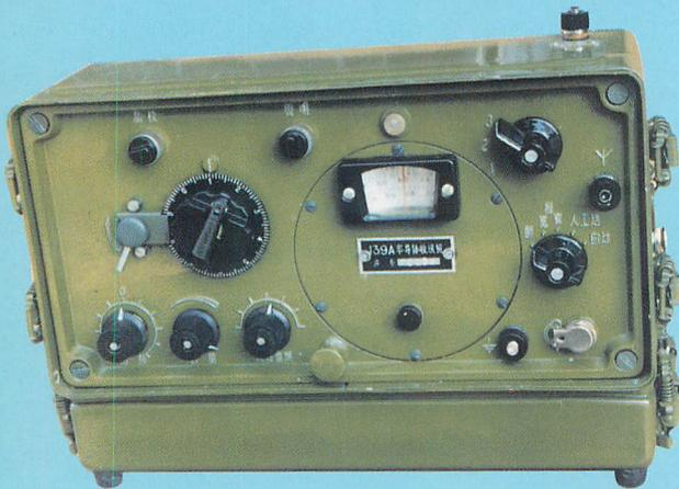
▲防水カバーを外したところ、右上のSWは1.5~3.6、3.6~8.5と8.5~18MHzの3バンド切り替えSW。パネルはダイキャスト製。
