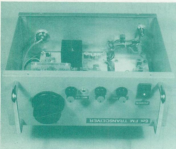
▲写真2 正面パネル側から見た内部。リアパネルの端子類の取り付け方はこのようになります。
