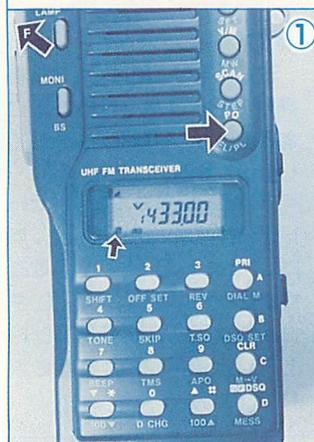
▲まず、Fを押しながらPOを押します。液晶表示板上にFL(周波数ロック)のマークが出ます。
