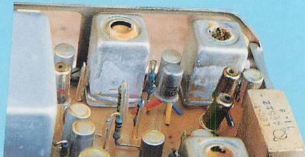
▲IFユニット。465kHz±2という文字が見えるのがセラミックフィルタ。その横に見える2本のトランジスタはIFアンプの初段でカスコードアンプである。
