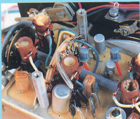
▲アンテナ回路とRFアンプ部のシールドケースを外したところ。中央のネズミ色のメタルキャンパッケージが3AG27と言うトランジスタ、こかもカスコードアンプ。
