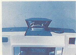
▲暗い場所ではストロボをセットする。ストロボ光が左右均等に行き渡るようにミラーが成形されている。
