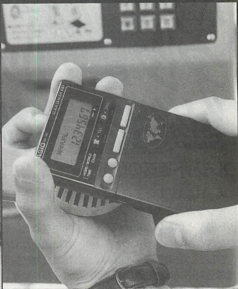
▲写真2 受話器の送話部分（マイク部分）に、トーンダイヤラをセットする。
