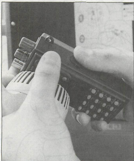
▲写真12 DJ-F 4 のように10桁のダイヤル機能が内蔵されている、オートダイヤラとして使用可能。この他にも、C460なども10桁以上のDTMFメモリを内蔵しているので応用可能。
