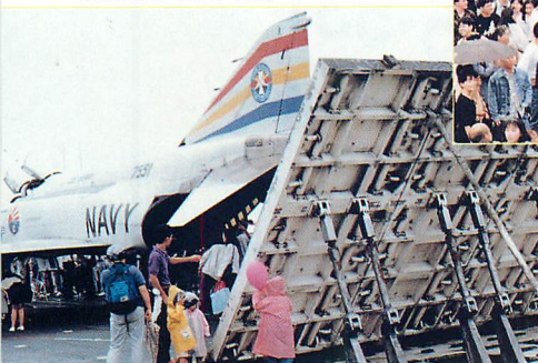
▲航空機の排気よけ、ジェットブラストディフレクタ。その前は、火災訓練用のF4。
