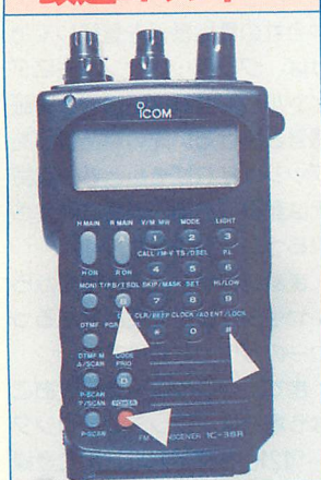
▲写真4 ハード改造後に、リセットしたら「B」「#」を押しながら電源をオンにします。
