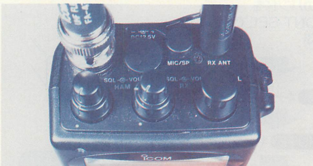
▲写真! トップパネルは、IC-2W とそっくりなんですが、「RX ANT」端子がある(右側)。これは、広帯域受信専用アンテナです。
