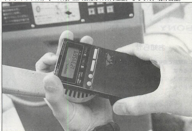
▲写真7 受話器のマイクの部分にこのようにセットして、ダイヤルボタンをポンと押せば、高速でピッポッパッとダイヤリングしてくれる。
