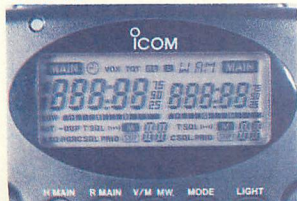
▲写真5 受信改造を受け付けるとLCD（液晶表示板）のセグメントがすべて表示されます。
