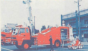
▲親車両「日本橋照明」とファイヤーサーチ。動力源は照明車の交流200V。
