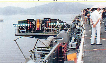
▲光学着艦装置。パイロットはこれを頼りに安全に着艦する。視認性のいいものは、美しくもある。航空甲板の左右両翼にある。空母の重要施設。
