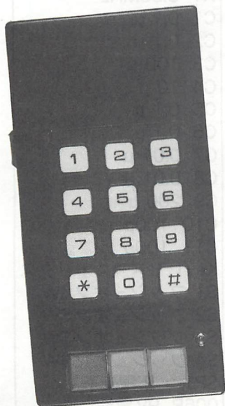
▲写真2 このようなケースに収めれば、使い勝手も良好です。加工の点からブラケースがオススメです。
