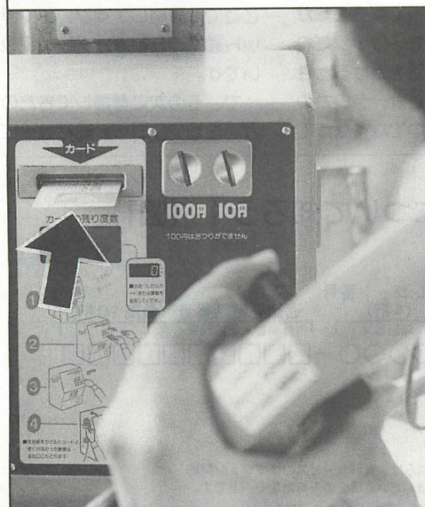
▲写真3 電話機のカード挿入口にカードCを入れる。このとき、受話器の受話部分（スピーカ部分）は耳にあてておく。慣れれば、カンでいくけど…!
