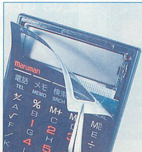
▲改造するにはまず、表面のシートパネルを慎重に剝がす。
