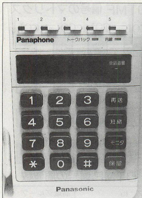
図4 電話用のDTMF信号12音の構成
