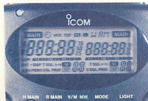
▲写真4 受信改造を受け付けるとLCD(液晶表示板)のセグメントがすべて表示されます。
