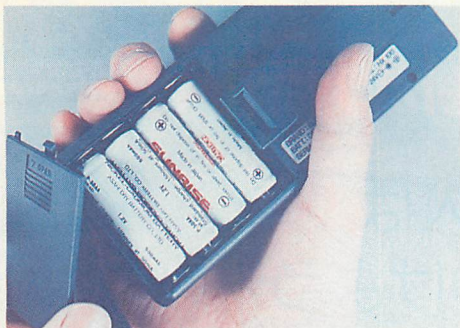
▲単3電池4本で使用可能。写真はオプションのニッカド電池をセットしたところです。
