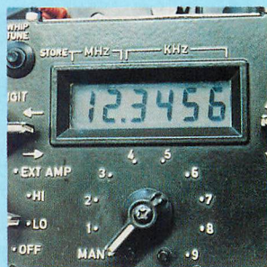
▲写真7 6桁のモノトーンのLCDは、けっこう大型で見やすい。フルークのデジタルと同じ大きさ。
