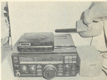
エミッターから洩れた搬送波を受信機でキャッチ。いい音で聴こえてました。(右チャンネルの2.8音でMHzを受信中)
