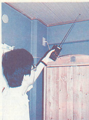
▶針が振り切っているので、アンテナを縮めて感度を落とします。
