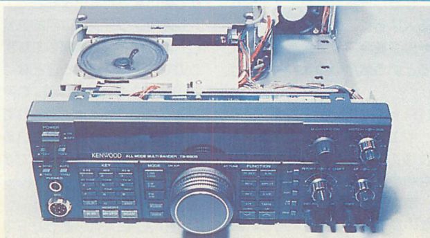
▲写真1 改造するためには、なにはなくともとりあえず本体を分解しなければなりません。まず、上ブタをこのようにして開けます。
