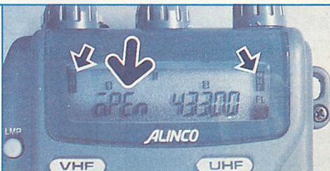
▲ [open] がクロスバンド・リピータ動作受付けの表示です。リピータ解除を受付けると [close] の表示が出ます。
