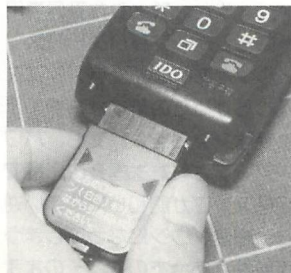
▲カーマウントキットという車載用の外部アンテナ接続ユニットのコネクタがこのようにつながる。
