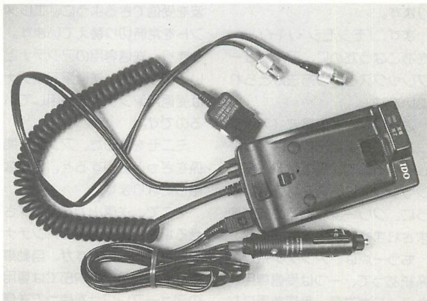
▲カーマウントキットには、シガープラグによって電源をミニモに供給する役割と、外部にアンテナを取り付けるためのアンテナケーブルの役割がある。アンテナケーブルは少し短い方が送受兼用のライン。
