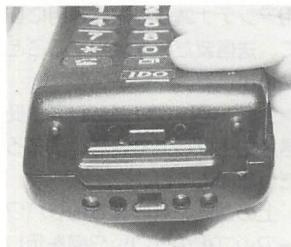
▲これがミニモのアンテナ出力端子。電源端子と同じコネクタは入っている。
