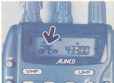
▲受信改造コマンドの [#212] を入力すると、open の表示が出ます。これが改造コマンドを受付けたという表示です。
