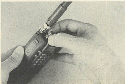
▲2バンドを完全独立させた結果、ANT コネクタと VHF のツマミが接近してしまった。
