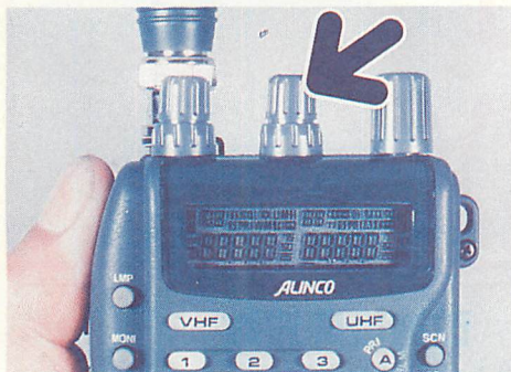
▲コマンド受信改造には必要ありませんが、リセットはFを押しながら電源オンで全部のセグメントが表示されます。
