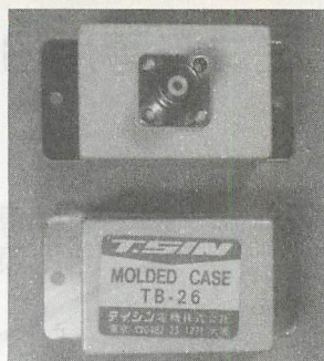
▲コネクタ取付け部分のケースは、テイシンのTB-26を使用しました。コネクタは、TNC型のメスをこのように取付けます。TNCコネクタはコネクタ専門店で購入できます。
