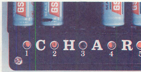
▲写真3 充電中は、LED ランプが点灯して充電電流がニッカド電池に供給されていることを表示してくれます。
