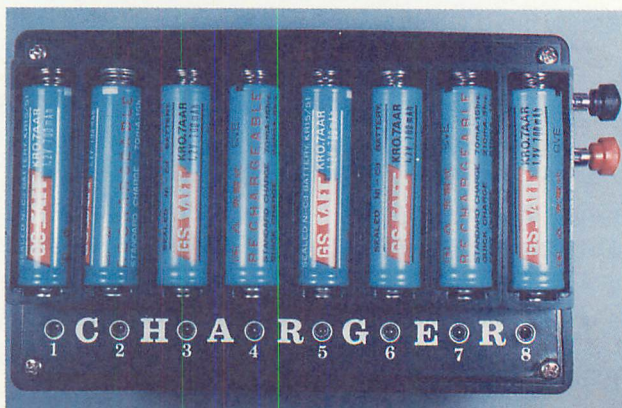
▲写真1 これが、完成後の1本×8・ニッカド電池チャージャーです。1本から8本ま で自由にニッカド電池を充電することができます。
