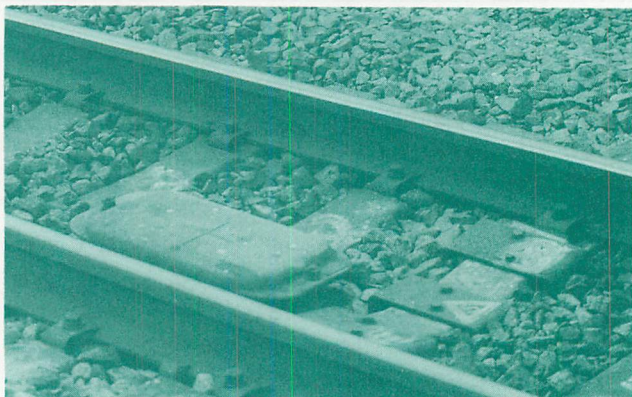
これがATS-S型の地上子だ。S型は全国津々浦々のJR路線で見ることができる。このほかにも、地上子を使うATSには、もっと小さな地上子のATS-P型もある。
