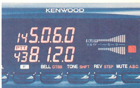
▲写真5 クロスバンドリピータの動作中には、このようにドットがたくさん表示される。
