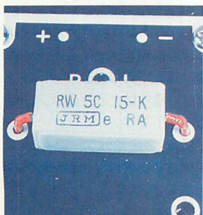
▲写真2 ディスチャージャの内部。専用基板はパネルに取付けます。
