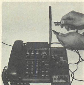
▲コードレスアンテナも導通性があるかをあらかじめ確認しておきます。
