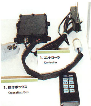
▲ 特定小電力を使用したクレーン用のリモコンシステム。
