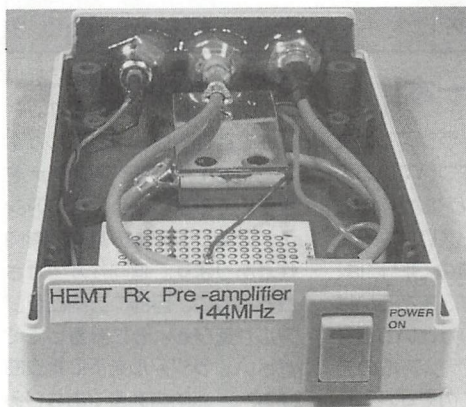
▲編集部で製作した HEMT プリアンプのユニット。フロントパネルは、電源スイッチだけです。
