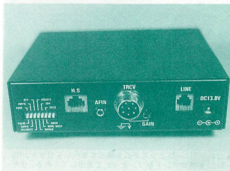
▲ TEL-55 の裏面。システムを組む HS-102 から、データを入力する端子も備える。
