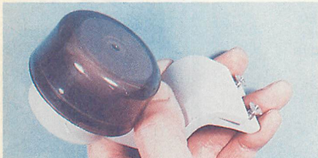
▲写真5 このようになっている最近のLNBは、円偏波専用の受信素子になっているので要注意です。
