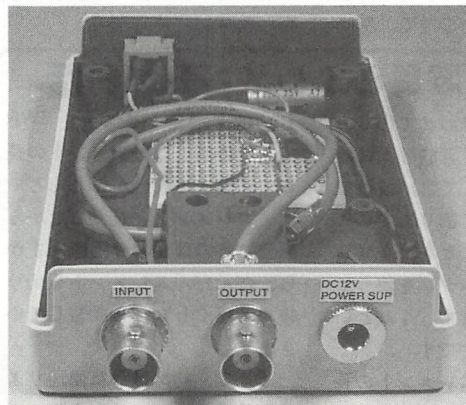
▲リアパネルには、入出力端子 (BNC コネクタ) と AC アダプタの電源端子を取り付けました。
