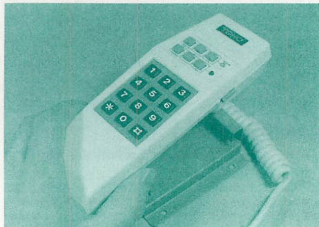
▲これがTEL-55とシステムを構成するハンドセット、HS-102。各種コマンドをワンタッチで送出してくれる。セキュリティ機能もバッチリ!
