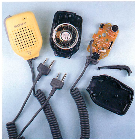
▲写真8 最後に付属のスピーカマイクも分解してみました。スピーカへの配線は、ポイントコンタクトによるリード線を使わない方法。スピーカ回りはシリコンでがっちりシール。
