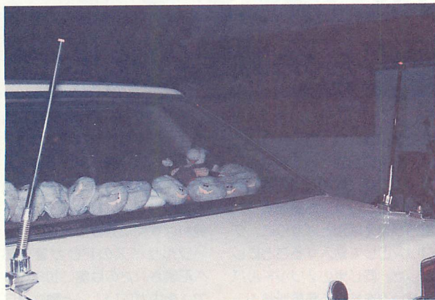
▲カーマウントキットからは2本のコネクタが出ているので、トランクリッドにも2本のアンテナを立てて、ダイバシティにすることになる
