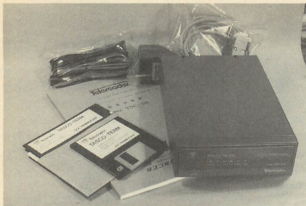
▲タスコ電機の初心者向け TNC、「TNC-201」。通信ソフト、RS-232ケーブルまでを付属、すぐにバケット通信がはじめられるぞ!!
