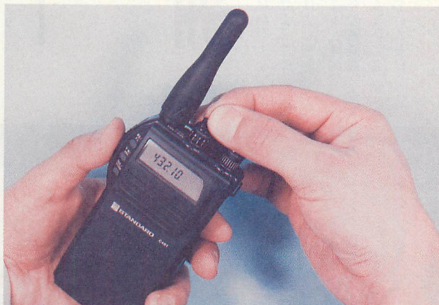
▲アンテナとの位置関係と、使いやすさを考慮して取り入れた音量ツマミが、外観の大きな特徴です。
