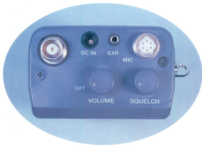
▲これは、トランシーバ本体を上から見たところ。シンプルですがアンテナ端子はTNCコネクタが使用され、マイク端子も通信工業用が使われています。
