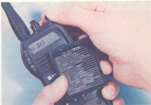
▲ディスプレイに現われるセットモードの機能番号は、キーボードのカバー裏面の機能表に対応しています。
