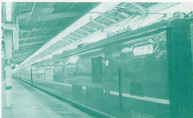
▲24系のブルートレインに組み込まれて運用されている、異色のパンタ付き電源車「スハ25 300番台」。△のスペースがインバータで占められている。
