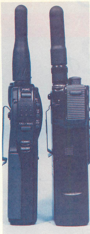
▲C481とC460の側面比較。ボディが薄くなり、PTT以外に親指で操作できるキーが現われました。
