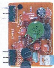
▲ MIC アンプ マイクアンプは、IR9022 (シャープ) が使用されています。
