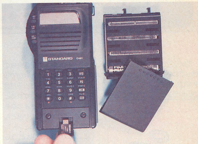
▲バッテリーパック(単三4本)、メモリユニットともにカートリッジ式で、オプションのユニットは200チャンネルまで記憶。
