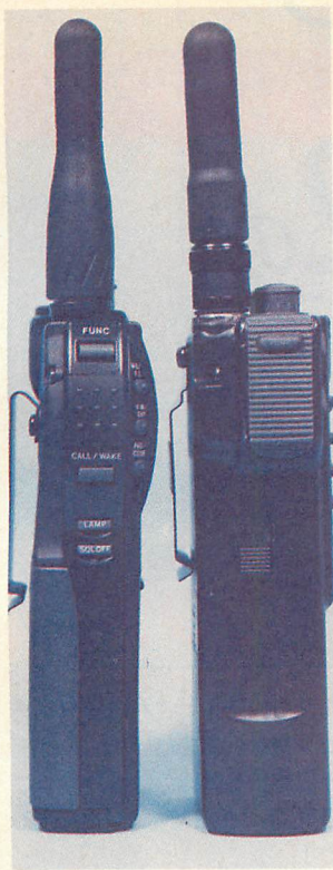
▲C481とC460の側面比較。ボディが薄くなり、PTT以外に親指で操作できるキーが現れました。
