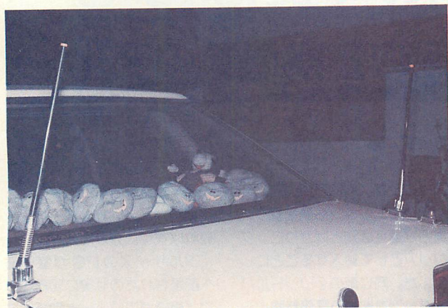
▲カーマウントキットからは2本のコネクタが出ているので、トランクリッドにも2本のアンテナを立てて、ダイバシティにすることになる
