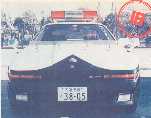
▲旧型の正面とアップ。フェンダーミラーが左右に付くものの、助手席にだけドアミラーが付いている。ルームミラーは1段で助手席用は吸盤貼付けの市販品を使用。散光式回転灯が普通の車両に比べて小さいのが分かる。
