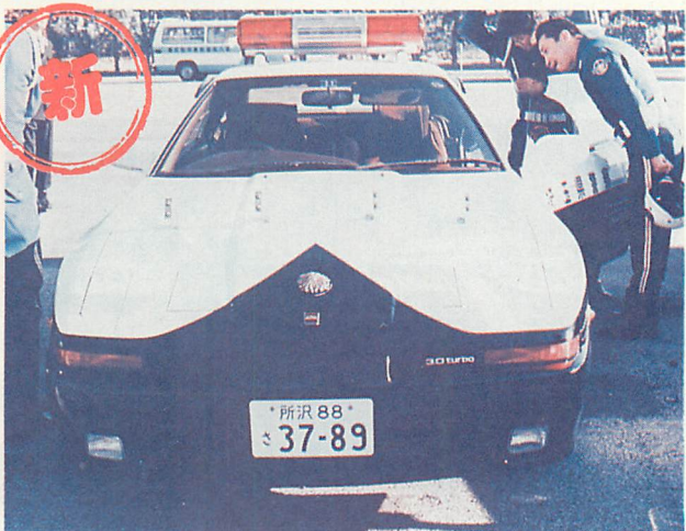
▲高速隊の連中が覗きこんでいる新型の正面とアップ。装備は全く変わらないが、マイナーチェンジ前後で異なるのはフロントバンパーのみ。こちらは左右ともドアミラーになった。旭日章はスーブラエンブレムの上にある。
