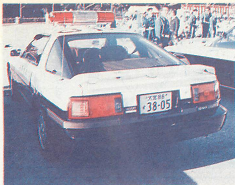
▲旧型リヤ。リヤエンブレムに注目。3.0GT リミテッドの表示がある。天井にはヘリ連携用のコールサイン、リヤゲート上のスポイラーには「埼玉県警察」の表示がある。太いタイヤは225/50R16を装着している。
