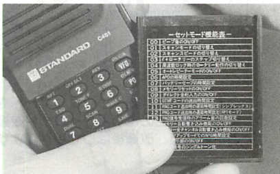
▶スライドカバーの裏には、機能セットモード機能表が付いている。これさえあれば、高度なセットモード操作も迷わずにおこなうことができる。
