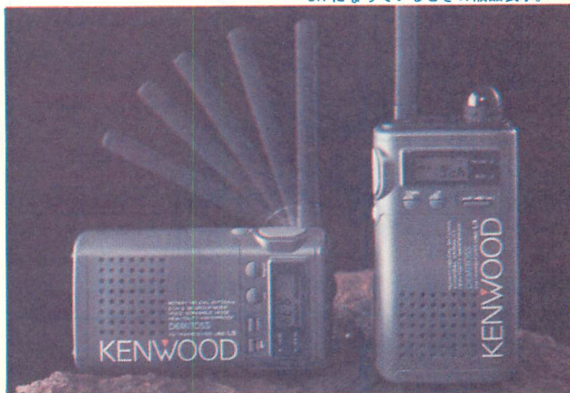
▲アンテナは90度おきに止まるから、TPOに応じて、無線線の縦・横が自由に選べる。本体裏の脱着可能なベルトクリップも90度ズラして取り付けられる。
