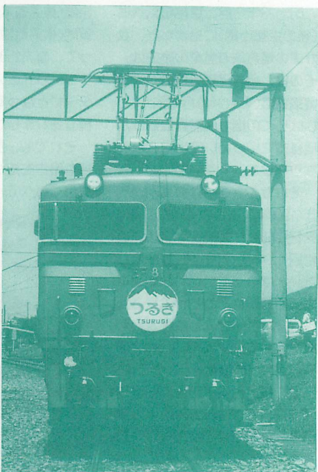
▲交直両用(50/60Hz)対応電機「EF81」。北陸本線をはじめとする日本海縦貫線で活躍している。また、関門トンネル用に改修を受けた400番台も九州で活躍している。
