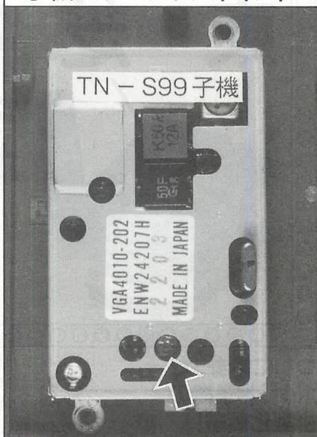
▲ RFユニットは松下製 ENW24207H です。矢印で示す VR を反時計方向に回していきます。VR はノンストップタイプなので回し過ぎに注意しましょう。
