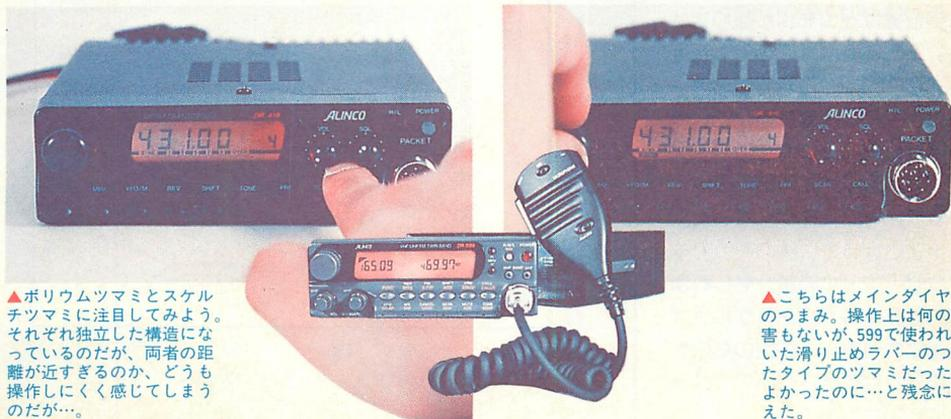
▲ポリウムツマミとスケルトンツマミに注目してみよう。それぞれ独立した構造になっているのだが、両者の距離が近すぎるのか、どうも操作しにくく感じてしまうのだが…。
