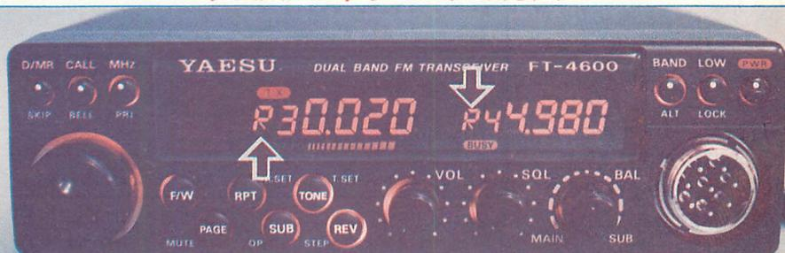
▲写真4 クロスバンドリピータの方法は、まず周波数を設定したら、いったん電源をオフにします。RPTキーを押しながら、電源をオンします。解除も同様の操作をします。なお、800→144MHzなどの一方通りピータも可能です。リピータ動作中は「R」の表示が出ます。
