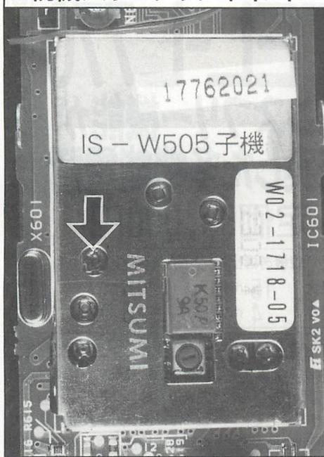
▲ RFユニットはミツミ電機製です(W02-1708-05)。矢印で示すVRを時計方向に回していきます。VRはノンストップタイプなので回し過ぎに注意しましょう。
