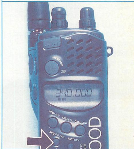
▲TH-K48の場合：MHzキーを1秒間押します。押すごとにバンドが切り替わります。TH-K28の場合：MHzキーを1秒間押します。押すごとにバンドが、145→340→118の順に切り替わります。108～136MHzは自動的にAMモードになり、表示器に“△”スピードマークが出ます。
