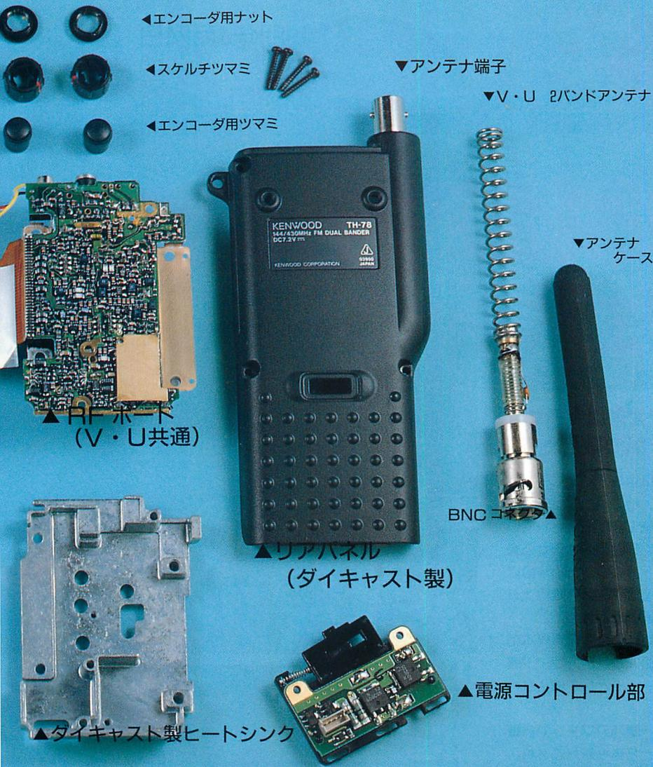
▶写真5 RFボードはこのように、リアパネルとダイキャスト製のヒートシンクによって完全にシールドされ、RFボードやCPUボードと干渉しないようになっている。当然放熱効果を高めるという意味もある。
