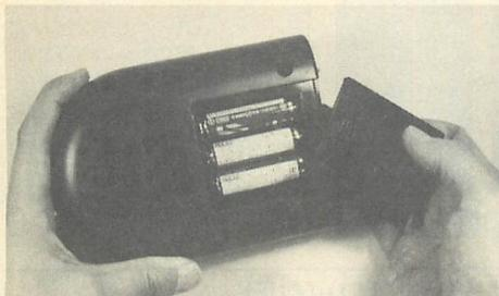
▲電源は単3マンガン乾電池3本。これでも1日3回点灯したとして、約3ヶ月間は電池交換なしで使用することができます。
