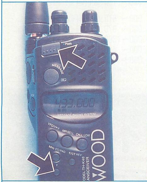
▲リセットは、Fキーを押したまま電源を入れます。液晶表示器の全キャラクタが表示されます。
