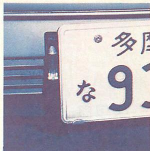
▲ナンバーに取り付けたOB-Sの発光部。小さな外観だが、光カプセルと受光部から構成されている。全体に強化プラスチックが使用され、エポキシでモールドしてあり耐久性に富む。
