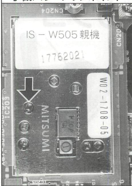
▲ RFユニットはミツミ電機製です(W02-1718-05)。矢印で示すVRを時計方向に回していきます。これもノンストップタイプなので回し過ぎに注意しましょう。
