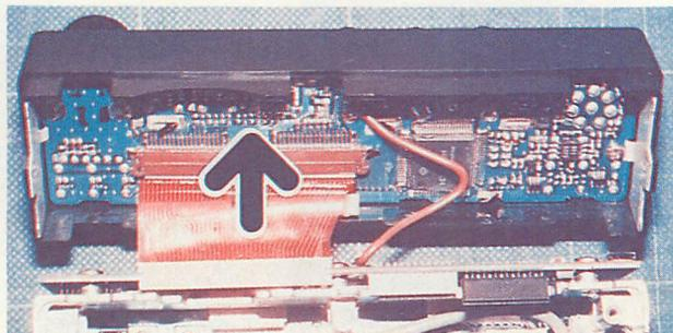
▲写真! まずこのように、本体からフロントパネルを外して、液晶表示器の裏側を見ます。
