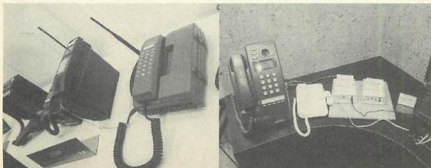
▲左はフランス製のデジタル移動電話で、右はコインピンクに一般電話をつなぐ機器
