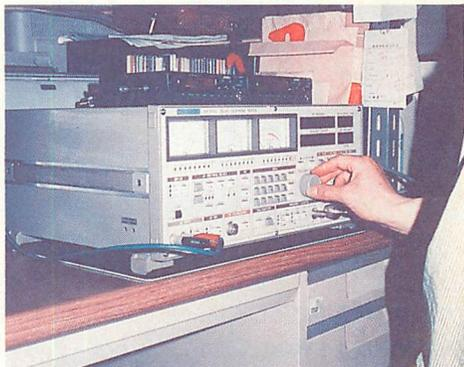
▲編集部無線機テスト「安藤 AH-5432」でそれぞれの受信感度を測定中。その結果は下のグラフのとおりだ。
