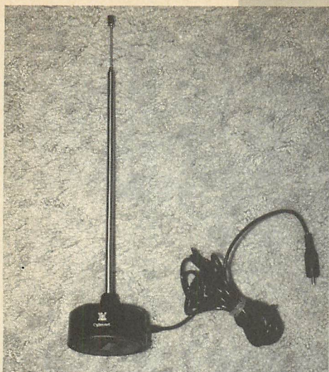
▲アンテナはロッド伸張式で、マグネット基台が装備されています。
