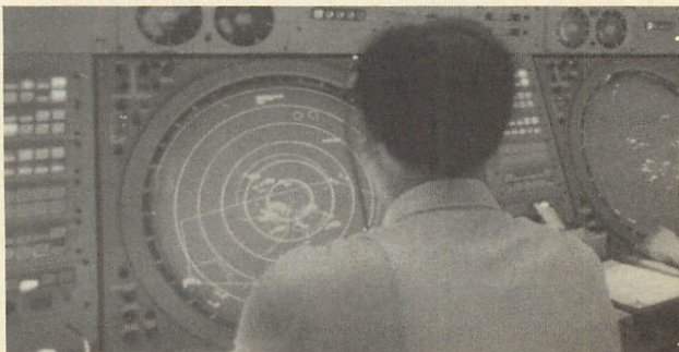
▲飛行場管制業務には、ガラス張りの管制塔で実際に飛行機を見ながら管制するタワーと、このように窓のないレーダールーム内で行なう管制がある。
