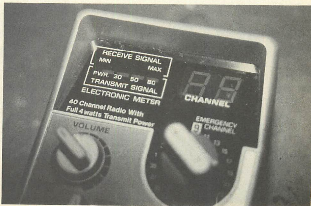
▲CH/S/RF 表示は一般的なLED 表示です。
