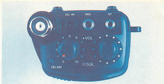
▲ 本体断面サイズは、TH-K27/47と同じ大きさだ。これは電池関係のオプション品を共用できるようにしたためで、便利さを優先した結果だ。
