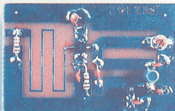
▲ノーマルに作ったプリアンプです。抵抗やコンデンサのリードは、できるだけ短くします。
