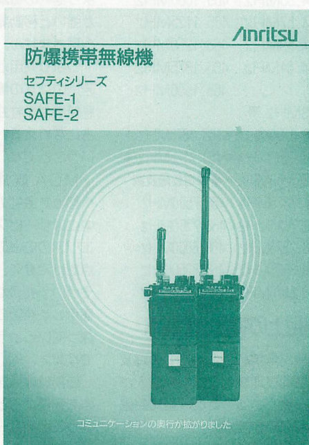
▲防爆無線機とは電源切断時火花が出ず、引火性ガス下でも誘爆せず安全であるという無線機。
