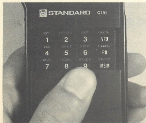
▲写真1 数字キーのスライドカバーは、運用中でも簡単に片手で開けることができ、素早くキー操作ができます。
