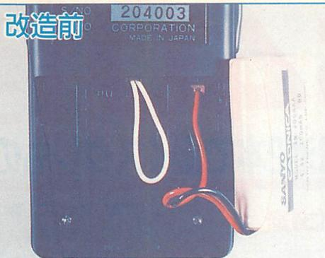
▲写真2 電池ケースを開けて、ニッカド電池をボックスから外すと、黄色いリード線が見えます。
