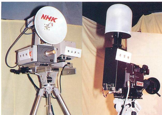
▲ハイビジョン・ワイヤレスカメラの受信セット（基地局）。使用周波数は41.75GHzで、伝送距離は約250m。NHK自慢のセット。パナソニック製。
