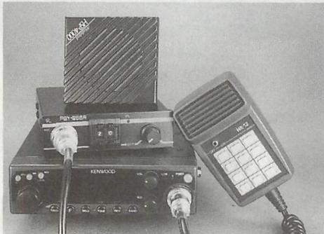
▲移動局のシステム。モバイル機に秘話装置、DTMF マイクが加わっただけ。シンプルなものでしょう。
