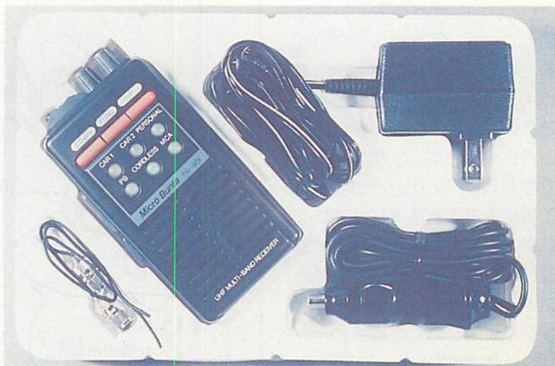
▲写真1 PR-901の本体はNi-Cd電池が内蔵されていて、そのチャージャ兼用のACアダプタとシガープラグ付ケーブル、専用アンテナがセットになっています。
