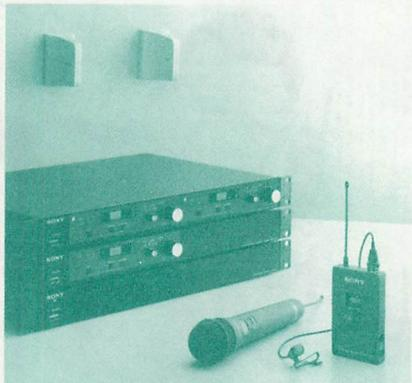
新設された800MHz帯を使用したワイヤレスマイクホンシステムで、この帯域は外周ノイズが少ないことが特徴。同時に送信出力も10mWと今まで2倍アップしました。ソニーのシステムPLLシンセサイザー方式を採用しているため、送・受信周波数の切り替えが簡単に現場での送信機との対応も迅速。ひとたびのエリアにつき最大6チャンネルまでのシステムアップが可能です。
