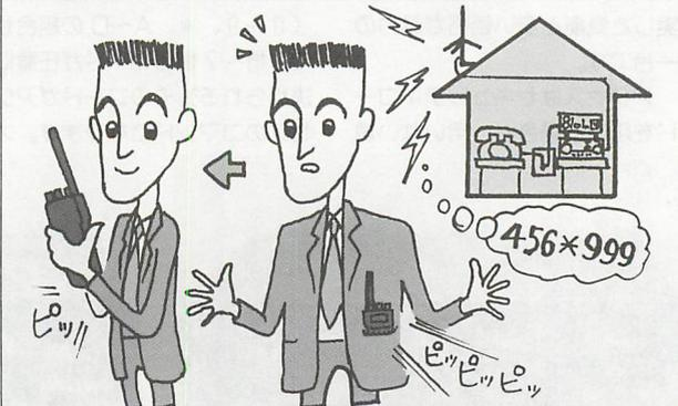
TEL-55は、着信時に、呼び出し音に併せてDTMFによるページングコードを送信する。ページャ機能付きのトランシーバでは、そのコードでアラーム音が鳴るので便利!
