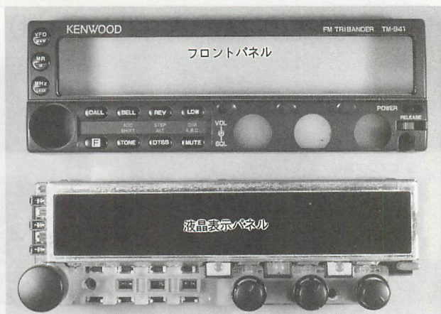
▲これは、TM-941のフロントパネルとその内部の液晶表示部分。液晶表示器の下には、フロントパネル内部の機能を制御するCPUが搭載されている。
