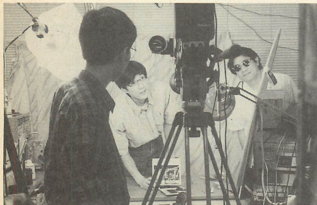
▲「送信改造ビデオバイブル」の撮影には東芝のハイ8一体型カメラ BCC-100も使った。しかし、デッキ部は使わず、カメラの信号をS-VHSデッキに入力し記録している。8ミリビデオの編集システムがまだ完全でないためだ。
