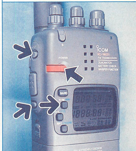
▲写真5 ハード改造後に受信改造コマンドを入力します。コマンドは、電源オフの状態から「MONI」キーと「V/M」キーと「LIGHT」キーを押しながら電源をオンにします。液晶表示のすべてのセグメントが出て、周波数表示に戻るまでこれらのキーを押し続けます。
