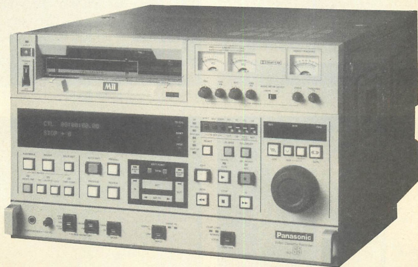
▲あこがれのM IIフォーマットのビデオデッキ、松下のAU-65。価格は1,900,000円。VHSカセットと同じ大きさのテープで1インチビデオ並みの映像を記録できるのだ。記録時間は最大90分。また、20分記録のスマールカセットをアダプタなしで使用できる。
