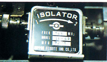
▲写真8 そして出力のアイソレータ。入力から出力まで、合計3個のアイソレータが使用されているのです。
