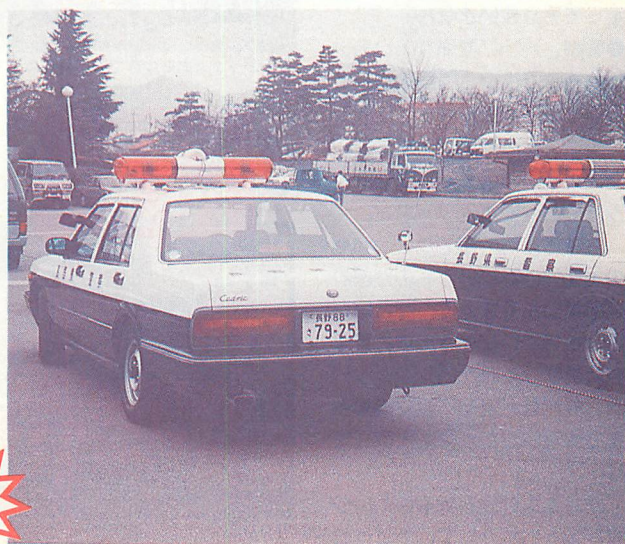
▲長野県警高速隊のセドリックです。散光式警光灯の中央部にレーダーを載せ、ドアミラーを装備しています。後部にはブレーキランプも見えます。
