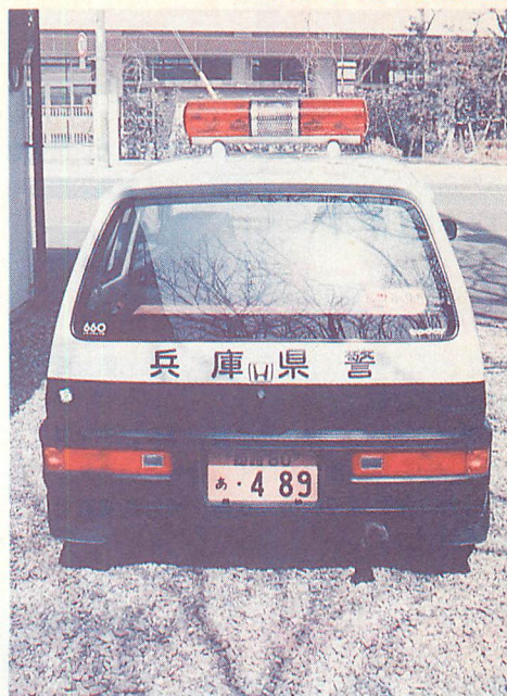
▲ルーフに載った小型散光式警光灯は、見てのとおり50Wサイレンスピーカを前向きにひとつ搭載しているのみです。
