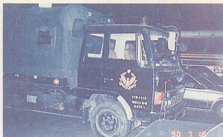
▲自衛隊のトラックのような幌をつけているのは、台北市政府警察局の人員輸送車(定員25名)。日野自動車の日野レンジャーを採用している。丸みを帯びた回転灯が楽しい。
