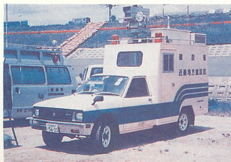
▲近畿地方建設局の現地利策本部として運営されていた、建設省の車両。ルーフの伸縮ポールつきテレビカメラに注目。
