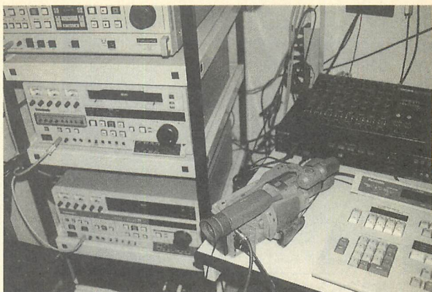
▲ソニーの3CCDカメラで撮った映像を、M IIデッキに立ち上げ中。いったん業務用フォーマットにコピーすることで、Hi8も編集システムに組み込める(下のコラム参照)。
