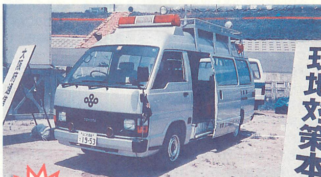
▲河川敷で大阪府の通信基地局として活躍した移動無線車。緊急車両の指定を受けた8ナンバーで、伸縮ポールも装備。
