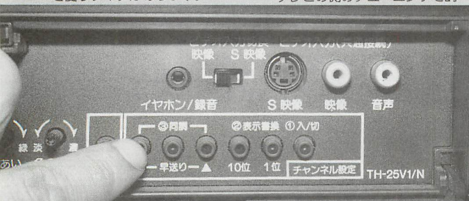
▲とりあえずチューニング調整をおこなってみる。電子チューナの場合がほとんどですから、ボタン操作だけです。
