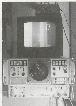
▲写真1 下からテストシグナルジェネレータ、ベクトルスコップ、モニターTVの順です。
