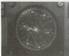
▲写真5 ベクトルスコープ管面。色信号のレベルがかなり抑圧されている。
