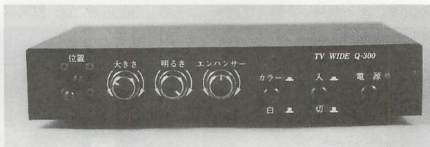
▲本体の様子。左端のジョイスティックで位置を定め、大きさツマミや明るさツマミで見易くする。カラー/白というのがモザイク/反転切り替え(実際は逆)。
