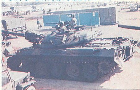
▲105ミリ自走榴弾砲を備えた74式戦車。ボディにペイントされた日の丸が、一際鮮やかに見えてしまう。排気マフラーは、いかにもディーゼルエンジンという感じ。
