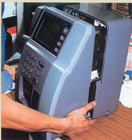
▲写真2 さていよいよ、DMC-2Cのご開帳です。当然、本邦初公開！ さよう体の構造は、フロントパネルと本体部分が分離するところまでは従来のMCシリーズと共通の機構になっています。
