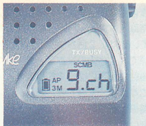
▲シンプレクス運用は、従来チャンネルで。スクランブル機能も内蔵。
