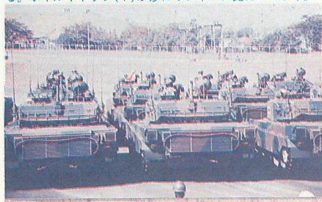
▲戦車を後方から見ると、後部デッキがあることに気付く。デッキ両サイドには大型のマッチングコイルを備えたホイップがあり、バラボラのように見えるのは出入口扉だ。
