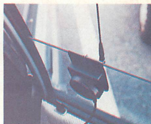
▲基台を内側から見る。大きな丸いツマミで、窓ガラスをはさみこむ力を調整する。ガラスにあたる部分にはゴムラバーが付いているので傷がつく心配はない。
