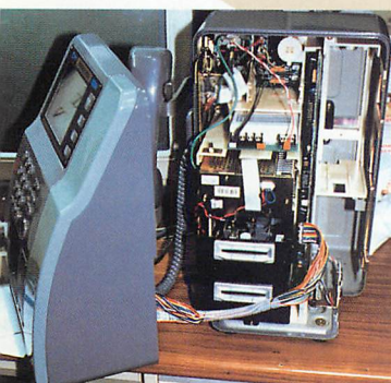
▼写真3 このように開くわけです。本体からフロントパネルにつながるラインは、2系統のフラットケーブルによっています。
