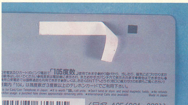
▲写真9 今回入手した10枚のニセテレカのうち、2枚のカードの紙テープの下には、なんとゼロ度数のパンチ穴が開かないようにした金属板が貼られていました。これは、このカードが使い切られたら再びニセテレカのベースとして、即、活用するための処置だと推測されます。
