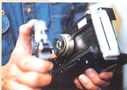
◀写真10 カードリーダはメンテナンスの効率を考慮してか、簡単に分解できるような構造になっています。上のユニットには、カード駆動のサブユニットと位置検出のセンサーが組み込まれています。下のユニットは、モータを含むカード駆動のメインユニット、カードパンチ、ヘッド、CPU ボードなどが組み込まれています。
