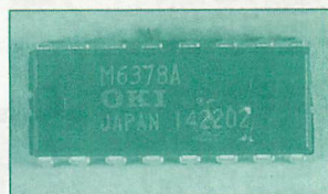
▲写真3 デジタル録音再生ICのMSM6378A。このICの中にカラス鳴き声のデータが入っていて、それをD/A変換しています。
