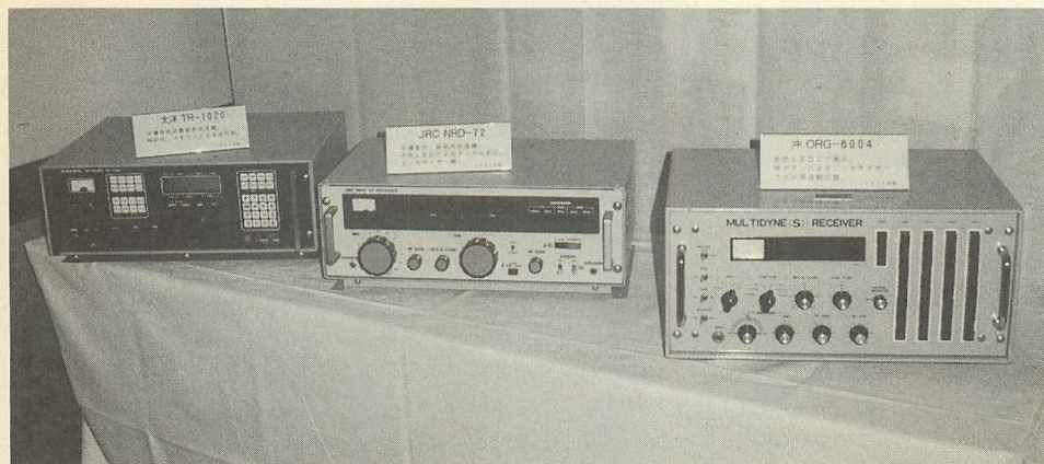
▲やはりホンモノの船舶用受信機は使い勝手が違う。向かって右から、「沖電気 ORG-6004」、「日本無線 NRD-72」、「大洋 TR-1020」。大洋といってもあまりピンとこないが、船舶無線機器では屈指のメーカーで、各地方電監の電波発信源探知システム「センサス」はこのメーカーが納入している。海上での方探ノウハウが陸上でも活かされているのだ。
