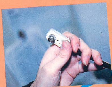
▲コネクタを付けたところ。なお、コンバータの電源はアンテナケーブルを通して送られる。
