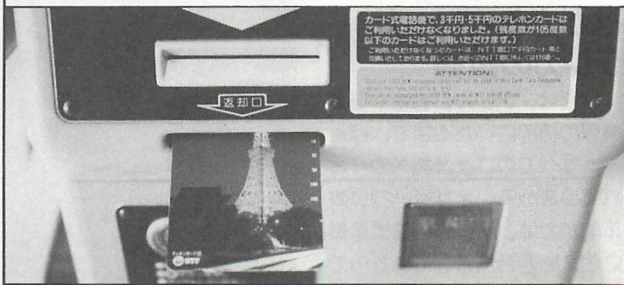
▲写真13 受話器を置いて「カチャン・カチャン・カチャン・カチャン・ズー」という音がしてテレカが排出されてきたら成功です。
