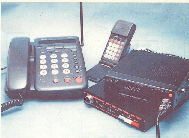
▲APC-11を使って、無線機とコードレス留守番電話とを接続。留守モードにセットすれば無線用伝言システムが完成！ 通常運用はコードレスホン子機をマイクとして、無線機から離れてQSOができるのだ。
