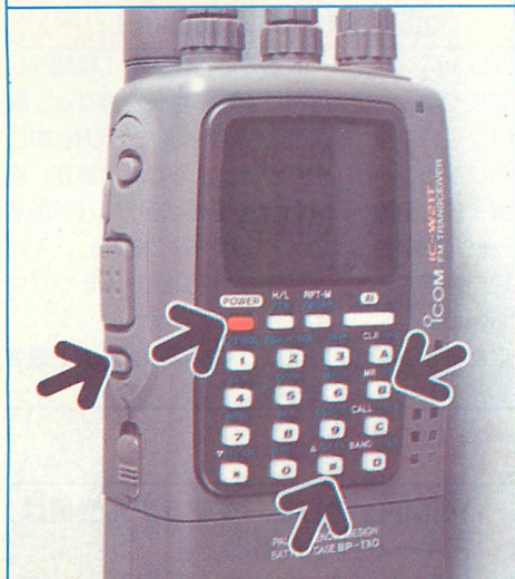
▲写真4 ハード改造後に受信改造コマンドを入力します。コマンドは、電源オフの状態から「B」キーと「#」キーと「LIGHT」キーを押しながら、電源をオンにします。液晶表示のすべてのセグメントが出て、周波数表示に戻るまでこれらのキーを押し続けます。
