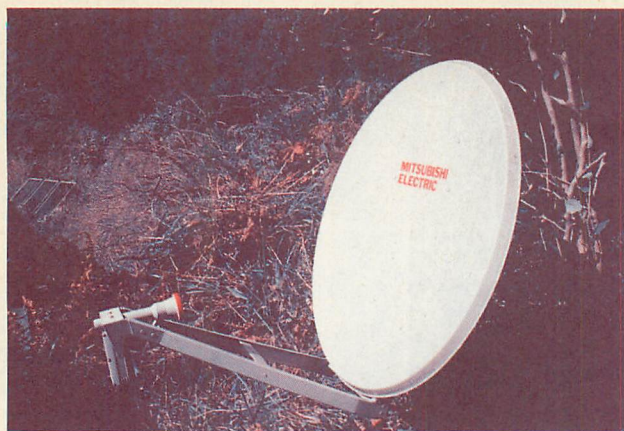
▲自宅の裏山に設置してある筆者の75cm CS アンテナ。当初は BS 受信用に設置したのですが、現在ではコンバーターを CS 用に交換して使用しています。アンテナの焦点に LNB の位置を合わせれば他社製品でも問題ありません。
