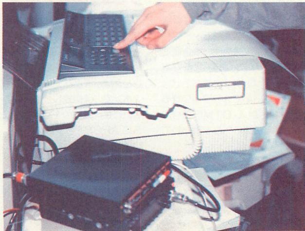
▲ APC-11を使って無線用ファックスを試す。G3モードでも問題なく送信できる。驚いたことにシンプレックスモードでもファックスが送れるのだ！ 秘密はデジタルディレイ回路内蔵のVOXにある。
