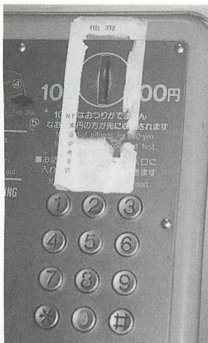
▲写真2 コインボックスの鍵の交換が終わった後の公衆電話。硬貨投入口のシールがはがされている。
