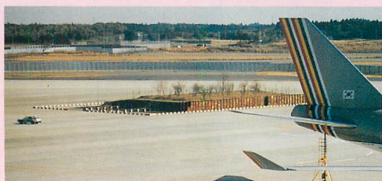
◀滑走路の中に箱庭が！？ 実はコレ未買収地。飛行機はこれを避けて速回りにタキシングする。
