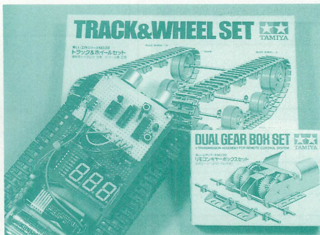
▲写真1 模型工作の強力な助っ人。田宮模型の「トラック&ホイールセット」と、「リモコンギヤーセット」。モータは別売で、2個必要。
