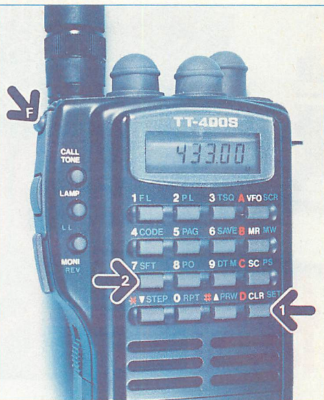
▲写真3 コマンドは、ファンクションキーを押し続けながら「SET」を押し「SFT」キーを押すだけです。
