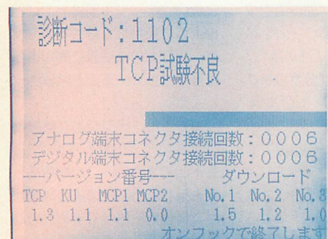
▲写真6 これは、メイン CPU ボードの TPC 試験の結果、不良だったことを示す表示。診断コードは [1102]。
