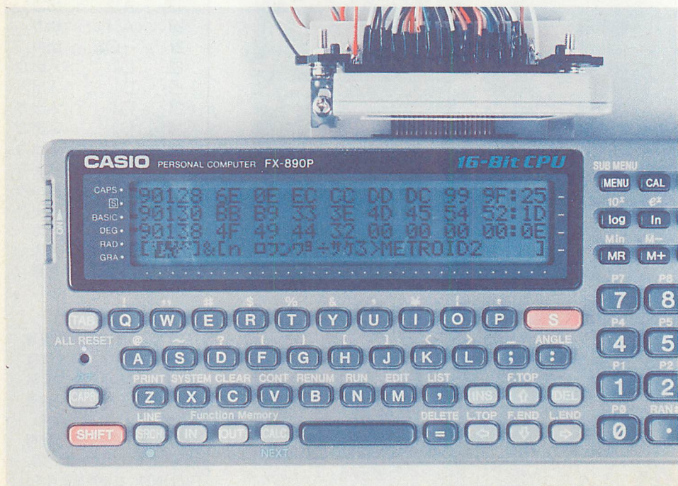
▲写真3 16ビットポケコンのI/Oポートにゲームカセット用のコネクタを付けて、データを吸い取る。
