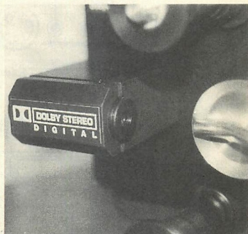
▲デジタルデータを読み取る、デジタルシステムの心臓部、ピックアップだ。
