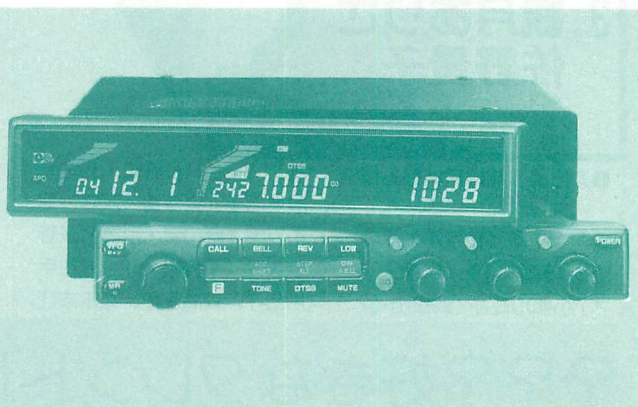
▲ケンウッドの TM-2400。2400MHz 帯初のモビルトランシーバ。画期的なりぐ!
