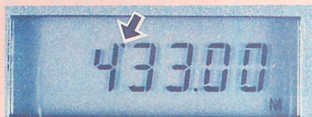
▲写真2 受信改造コマンドが入力されると、100MHz 台の周波数表示の右上に小さな点が表示されます。
