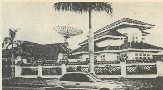
▲図5 インドネシアでも衛星放送、アンテナは赤道近くのため真上になる。
