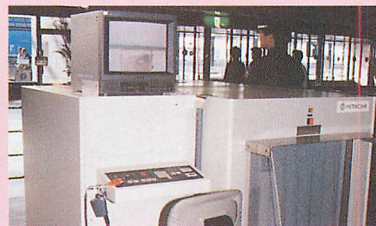
▲検査器は中の様子をカラー映像でディスプレイに映し出す。
