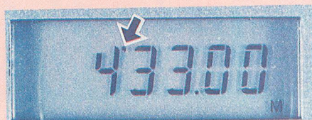
▲写真2 受信改造コマンドが入力されると、100MHz 台の周波数表示の右上に小さな点が表示されます。
