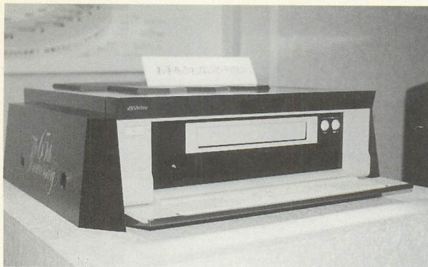
▲W-VHS デッキ。テープはメタルテープを使うものの、メカは VHS の延長線上にあるものなので、上位互換性やコストダウンが図れる。
