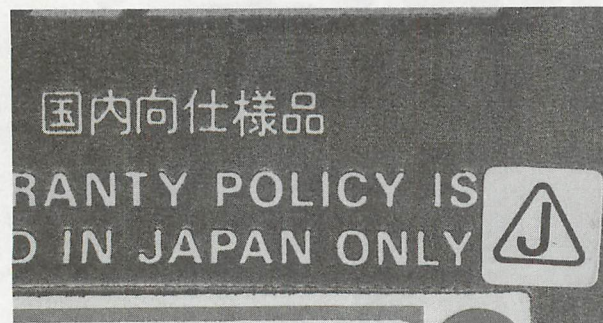
▲無線機に印されている“Jマーク”。当初は送信改造できないことを意味していたが、受信規制対応レシーバにもマークされるようになった。
