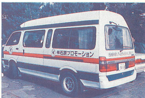
▲石原プロモーションの専属ロケ車、トヨタハイエース・ロイヤルカスタム。ルーフトップのアンテナこそ、石原プロが使用している簡易無線(468.7875MHz)用のものだ。
