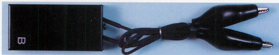
▲写真7 電話回線専用盗聴器(ほぼ実物大)。電話の片側の線の間に直列に挿入されるタイプ。電源不要。写真はVHFタイプ。
