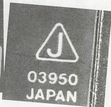
▲無線機に印されている“Jマーク”。当初は送信改造できないことを意味していたが、受信規制対応レシーバにもマークされるようになった。
