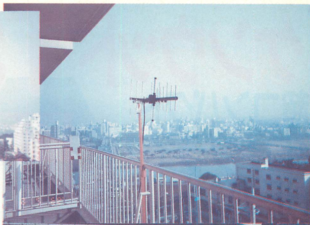
▶受信アンテナ。TV用のアンテナを流用。
