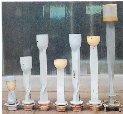
▲写真6 各種輻射器。水平偏波用のタイプは、根元で90度ねじれている。右端のものは、受信用のものらしい。
