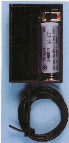
▲写真7 電話回線専用盗聴器(ほぼ実物大)。電話の片側の線の間に直列に挿入されるタイプ。電源不要。写真はVHFタイプ。
