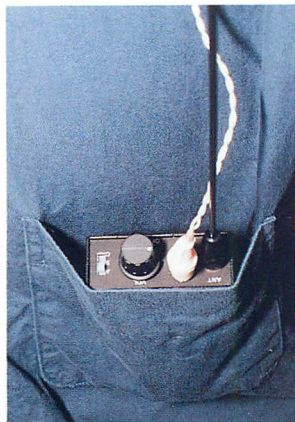
▲写真3 専用の受信機は、ポケットにすっぽりと収まってしまうほど小さい (写真は UHF タイプ)。
