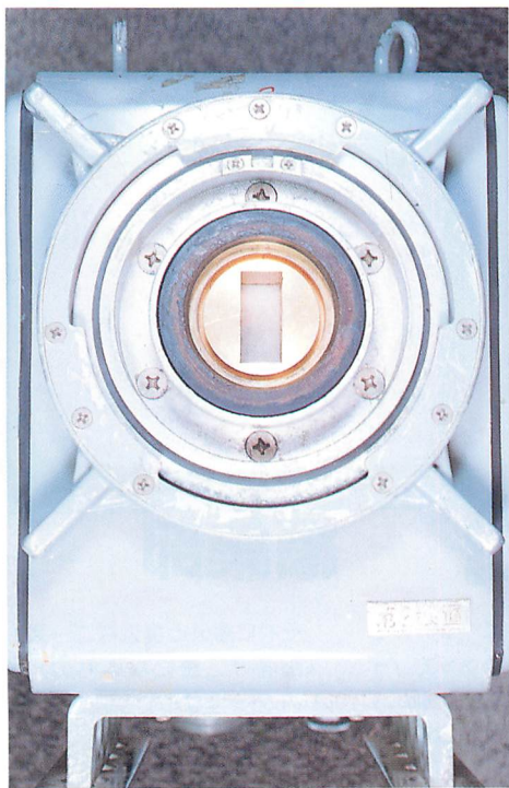
▲写真5 送信機の正面。パラボリアンテナを取り外した状態。導波管のスリットは縦長なので、この状態では垂直偏波ということになる。水平偏波として使うには、輻射器の水平偏波用を使用する(導波管が90度ねじれたタイプ)。マウント部分は、潜水服のコックのような構造になっていて、コックを60度回して、強力に結合させるようになっている。
