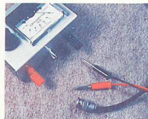
▲手持ちのものに合わせてBNCとテストリードの2種類を使い分けることができます。
