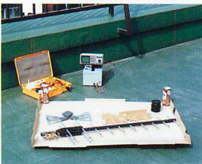
▲10エレ UHF テレビ用アンテナはほとんど完成品の状態で販売されています。同軸ケーブルやコネクタを別に用意して取り付ける程度で即使用できます。
