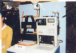
▶日立の報道支援システム「ハンディバック」。小型FPU、モニター、電源を備えている。事故、事件現場での機動性を高めるのだ。
