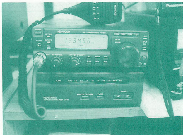
▲そのコンパクトさで、一躍人気トップHF機となったTS-50。送信改造もできるぞ!
