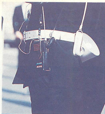
▲誘導担当のPMが使用していた携帯無線機。本体にはTK1048/2.4.5…とある。全面デジタルといえども、警備にはアナログ機が欠かせない。
