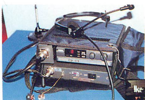
▶日立の報道支援システム「ハンディバック」。小型FPU、モニター、電源を備えている。事故、事件現場での機動性を高めるのだ。
