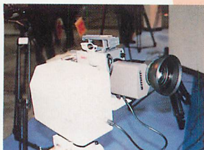
▲ダイワのリモン装置を備えたカメラ。
