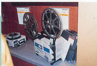
◀光学メーカーのエルモは、プレゼンテーション製品を数多く展示。これは、16ミリフィルムをビデオに変換するテレシネ装置。
