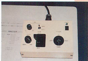
▲パン、ティルト、ピント、ズームが手元で操作できるリモン。
