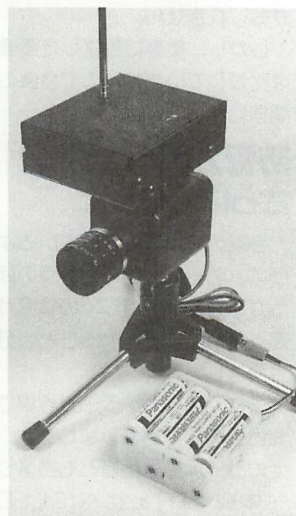
▲ CCD カメラとトランスミッターを組み 合わせる。電池で動くのがミソ。ラジコン搭載もこのスタイル。
