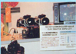
▼▲キャノンは手ブレ防止の「イメージスタビライジングズームレンズ」を強力にアピール。レンズに仕掛けがある。光学式なので、画質の劣化がほとんどないのが特徴。
