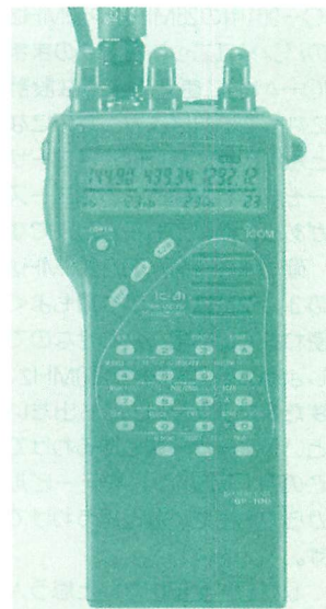
▲144/430/1200MHzの3バンドを内蔵したIC-Δ1。その太さから*ようかん*と形容される。
