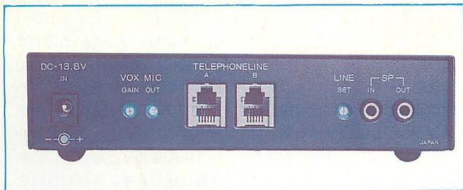
▲ TA-220裏面。TA-210ではネジ止め式だった電話ラインの端子がモジュラー端子に変更、より使いやすくなった。本機とトランシーバを接続することにより親機を構成する。
