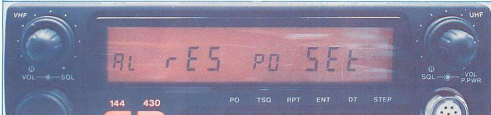
▲写真5 C5700には、リセットのモードが3つありますが、改造後におこなうリセットはオールリセットです。FNCキーを押しながら電源を入れたときの写真のような表示になります。左端の表示が【AL】でない場合には、メインダイヤルで【AL】を選択します。そしてMSキーを押すと【POSET】の表示が【SCGO】になり、最後にSCNキーを押すと電源が一瞬切れた後、自動的に入りオールリセットが完了されます。
