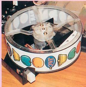
◀写真7 3本あるドラムユニットの一つ。絵柄は21枚で、モータはステッピングモータが使用されている。
