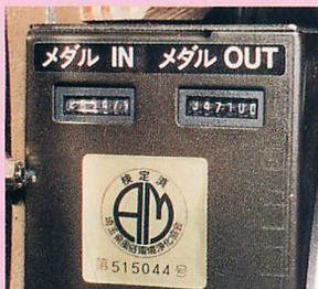
▲写真6 メダルの投入枚数と、払い出し枚数が6桁の電磁カウンタに記録されている。
