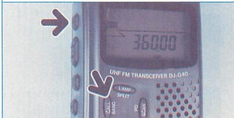
▲写真6 バンドの切り替え方法は、FUNCを押しながらBAND(CALL)キーを押す毎に変化します。[433MHz → 145 → 360 → 870 → 433 → …]の順です。
