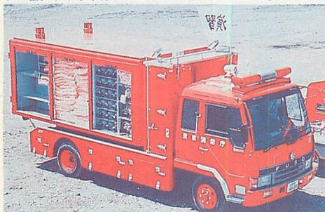
▲立川署の資材搬送車「立川 ST (輸送)」。後部は可動式コンテナになっていて、地面に降ろすことができます。
