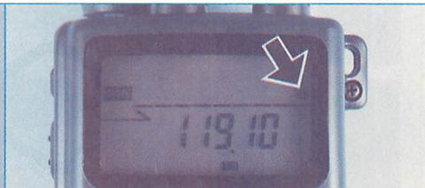
▲写真8 AM受信モードでは、LCDの右上に[A]のマークが出ます。AM受信モードは、各バンド個別に設定します。
