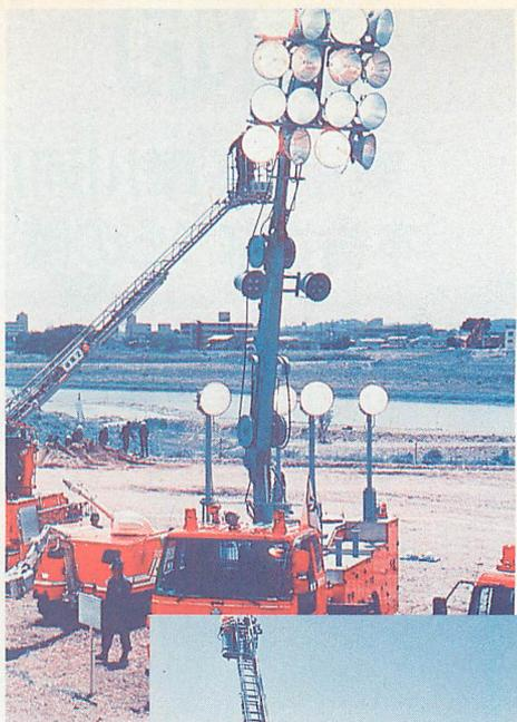
▲昼間でも相当明るかった照明電源車 (SS) はディーゼル発電機を搭載。他の車両にはないメカニズムと投光器の大きさにただただ圧倒…。
