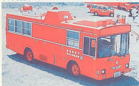
▲日野自動車の大型バスを改装した調布署の「調布 SM (水難)」は大規模災害時に出動。シャワールームも完備している。
