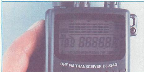
▲写真5 リセットは、FUNCキーを押しながら電源オフの状態からオンにします。LCDにすべての表示が表れればOKです。
