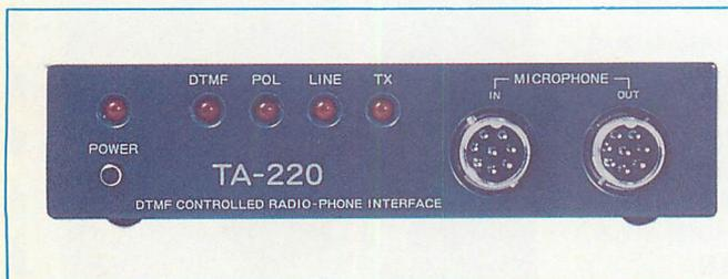
▲ホーンパッチインターフェース・TA-220。デュープレクス（同時通話）方式の他にシンプレクス方式にも対応する。
