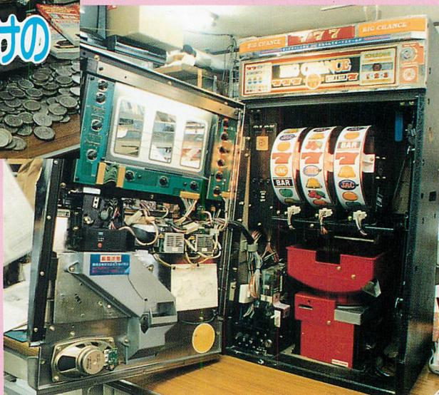
▲写真1 パチスロマシンの内部を開けて見たところ。パチンコ屋さんでも、コイン補充やメンテのときにちょっとだけ拝むことができます。トラブルったときに、店員さんが直ちに対応できるように、メンテ性抜群の構造になっている。
