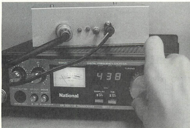
▲50MHz のトランシーバと組み合わせて27MHz にオンエアする! もちろん28MHz アマチュアバンド用にも使える。
