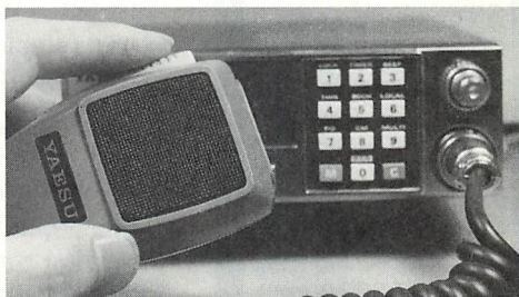
▲モニター状態からでもマイクの PTT を押すだけで送信が可能。割り込み自由自在だ。もちろん、ノーマル機では不可。
