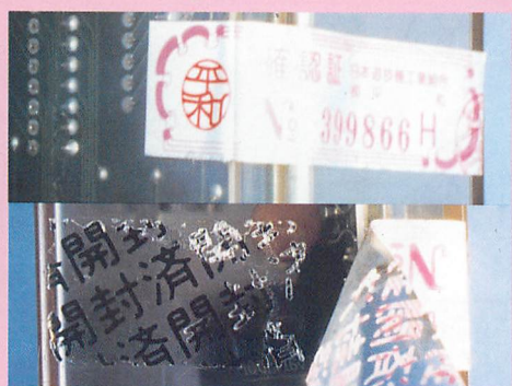
▲写真14・15 コンピュータ基板を収納している透明ケースには、日本遊技機工業組合の連番シールが貼ってある。このシールをはがすと、しっかりと「開封済」と出てくる。
