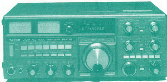
▲144/430帯を内蔵、オプションで50MHzも用意されていたFT-726。エポックメイキングなV・UHF機だったのだ。
