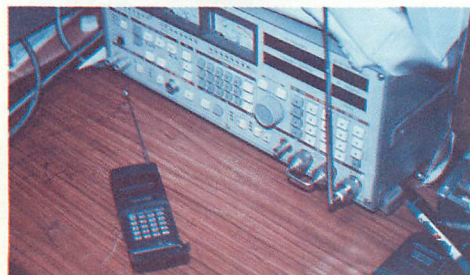
▲SSGにアンテナを付け、微弱な電波を受信して比べてみたが、これといって大きな差は出なかった。
