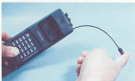
▲フレキシブルアンテナは折れないのでハンディトランシーバにはベストなアンテナといえる。
