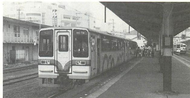
▲真岡鉄道の車両はレールバス、右後方のJRより小さめ。
