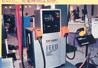
▲電気自動車はディスクチャージしたらガソリンスタンドならぬ電気スタンドでエネルギーを補充する。写真は、電気自動車に充電するための充電器で実際に使われているものだ。充電時間は30分。
