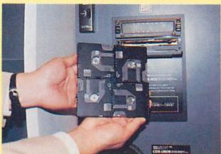
▲ソニーはカーオーディオ用のMDプレーヤーを新たにリリース。写真はMDを4枚内蔵するMDチェンジャーのディスク装着部。手のひらにのるコンパクトさだ。
