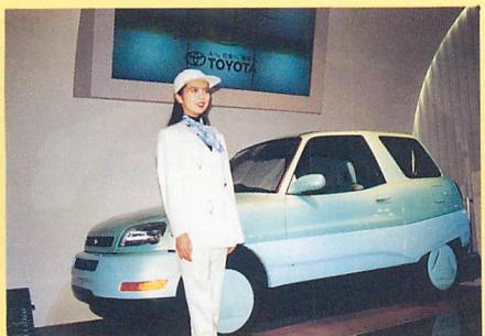
▲トヨタの意欲作、電気自動車EV-50。家庭で充電可能で、最高速度時速115km、走行距離110km（都市内走行）を誇る。
