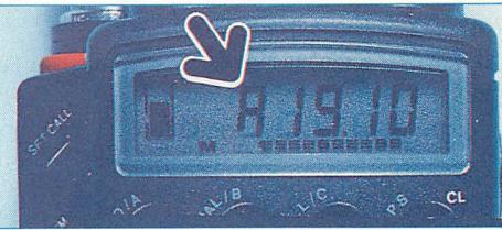
▲写真6 100.000MHz～138.995MHzは、周波数を設定するだけ自動的にAM受信になり、その他の周波数でのAM受信は、セットモードでAMを選択してonにします。AM受信中は100MHz台の表示が[A]になります。
