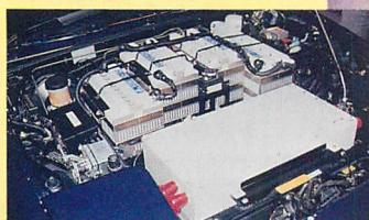
▲ロードスターEVのトランクルーム。バッテリはニッカド電池、動力は交流モーターだ。エンジンルームがオイルで汚れないのはいい。
