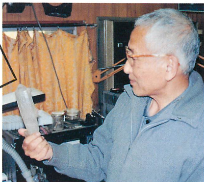
▼これが水晶原石。しかし、このままでは不純物が多く使いものにはならない。実際に無線機で用いるのは、原石をいったん溶かしてから結晶させた工業用クリスタルだ。この原石は見学に来た人に見せるため置いてあるとのこと。
