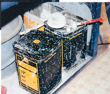
▼研磨器のターンテーブルにまくアルミパウダ。きめ細かいヤスリの役割を果たす。
