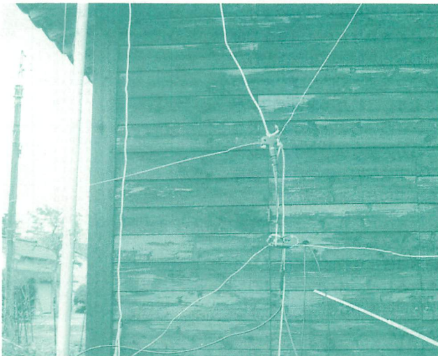
▲滑車とロープで給電部はすぐに降ろせるようにしている。これで、調整が楽にできるようになった。
