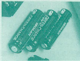
▲秋月電子通商で売っているニッケル水素充電電池は1000mAhと1200mAhの2タイプあり。
