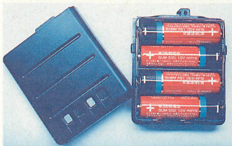
▲最低動作電圧は4V。そのためバッテリーバック内は、単3が4本だけだ。
