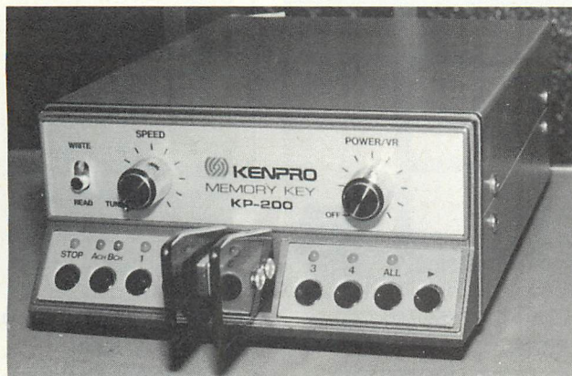
▲キーも付いたメモリーキーヤー。これはケンプロ製で、「メモリーキー」という名称が使われている。
