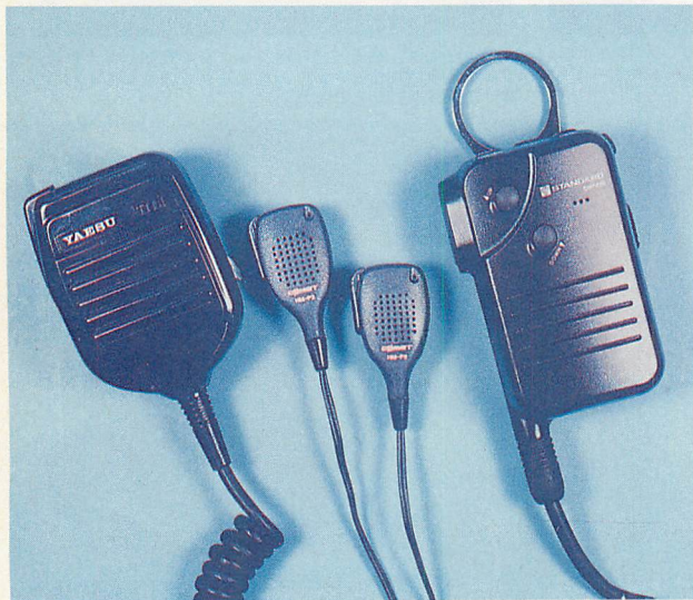
▲マイクの大きさを比較。プチマイク (中央) がいかに小さいか分るだろうで、この大きさにスピーカとマイクが内蔵されているのはすごいのでは。
