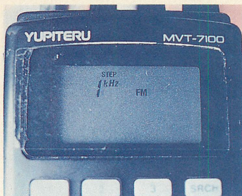
▲ MVT-7100は右から数字が左へ押し出されていくように表示します。
