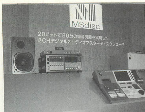
▲写真11 ソニーの5.25インチ専用光磁気ディスクを使ったデジタルオーディオレコーダー。16ビット/100分、20ビット/80分、24ビット/65分の録音が可能。
