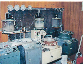
▼研磨器のアップ。ターンテーブル上になっていて、そこが回転する。原石はターンテーブル表面に押しつけられ、研磨剤で削られていく。
