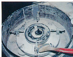
▼研磨器のアップ。ターンテーブル上になっていて、そこが回転する。原石はターンテーブル表面に押しつけられ、研磨剤で削られていく。
