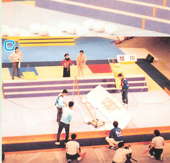
▲写真12・13・14 見事優勝に輝いた、旭川高専の「ジムカデ」号。最初は、写真Aのようにロールケーキのように丸まっている。これが、あれよあれよという間に広がって(写真B)、フィールド一杯に広がる。これで、自陣に入るボールを完全にブロックするのだ。
