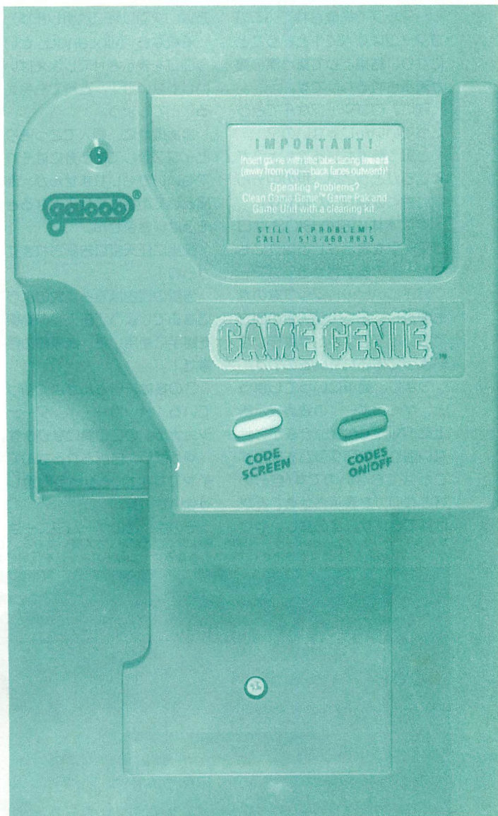
▲写真8 ゲームジニーを正面から見たところ。下半分は、ゲームボーイのカセットスロット部分にすっぽりと納まるようになっている。電源はスロットインでゲームボーイから自動的に供給される。
