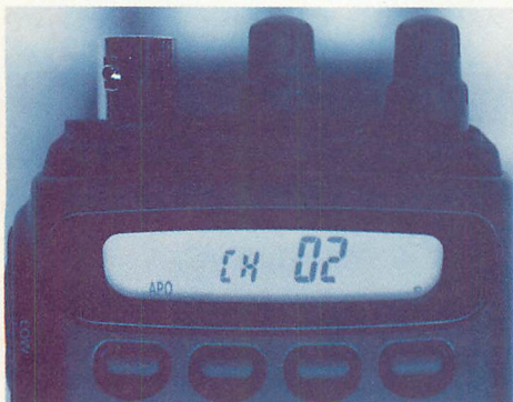
▲メモリをチャンネル表示モードで動かすと、メモリした周波数しか使えない。VFOを扱えないのだ。こうなると特小機並に成り下がってしまう。
