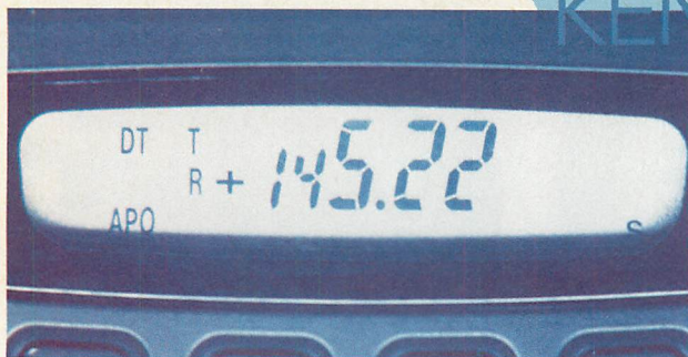
▲2m 機なのに、シフト表示やリバース機能もある。トーンジェネレータ、コードスケッチも標準装備だ。
