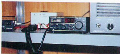
▲アイテックの50MHzFMの10W トランシーバキット、TRX-60Iが実際にセットされていた。ロケーションのいいこともあって神奈川の局ともグラウンドウエーブで交信できるとのこと。
