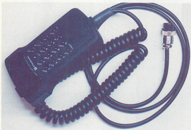
▲スピーカマイクに付いているカールコードには、尾部にさらに1mのストレートケーブルが付いている。本体から、かなり離れて運用できる。
