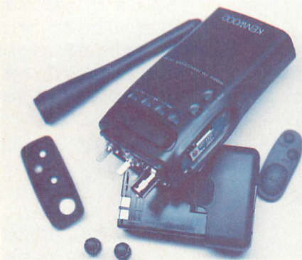
▲上面と PTT スイッチ部のラバーキャップは簡単に外れる。手だけでも、ここまでバラけやうのも一興だ。
