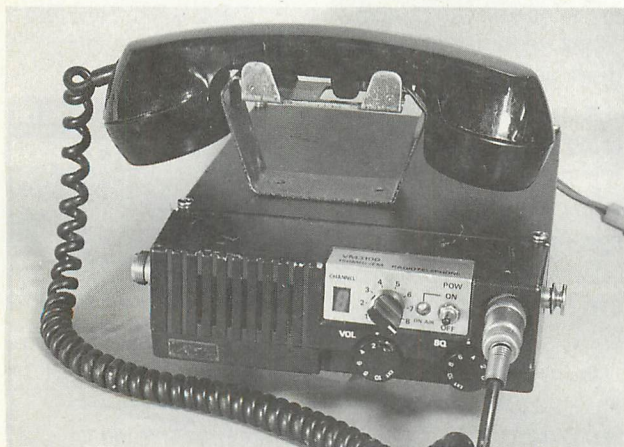
▲消防/救急用に活用される沖電気工業のVM3100。142~162MHzをカバーする広帯域設計。もちろんアマチュア用としても使える。頑丈さは一見の価値あり。シャーシも厚いものを贅沢に使っている。
