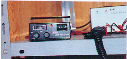
▲アイテックのVHF 帯広帯域レシーバキット R-100も稼働中。この受信機は、消防団などのニーズに応えるべく開発されたもの。地元の消防波が快適に受信できた。
