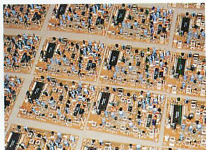
▼調整用デスクの上には、VHF 受信機 R-100の基板が整然と並んでいた。
