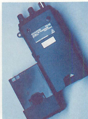
▲電池ケースは、ケース側の爪で本体に止まるようになっている。
