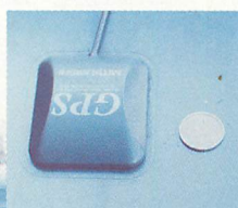
▲アンテナはトランクに装着。10円玉と大きさを比べて欲しい。この超小型アンテナで、十分な感度を得ていた。
