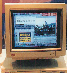
▲Windows上で動くパソコンテレビ会議システム。モニタTVの上にあるのがカメラ。ISDN回線を使ってカラー動画と音声をやり取りできる(東芝)。
