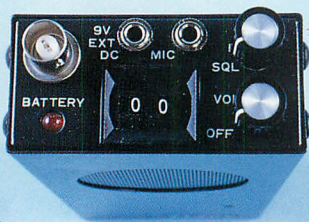
▲アイテックのキット、ゼロ-1000。PLL 方式の FM トランシーバながら9,800円という低価格! 大人気のキットだ。29MHz と 50MHz の 2 種類がある。
