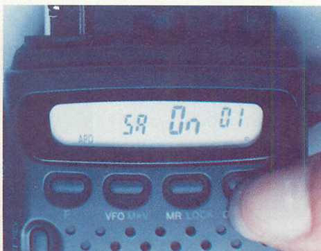
▲セットモードはコールボタンを押しながら電源オン。これで16種のアイテムセットができる。16種とは、まさにコンピュータ動作の典型的な数だ。
