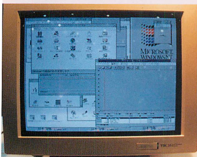
▲Windows上で動くパソコンテレビ会議システム。モニタTVの上にあるのがカメラ。ISDN回線を使ってカラー動画と音声をやり取りできる(東芝)。
