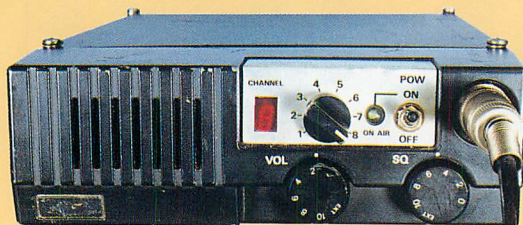
▲ VM3100、正面パネル。8チャンネルまで内蔵可能で、インジケータがチャンネル表示をする。
