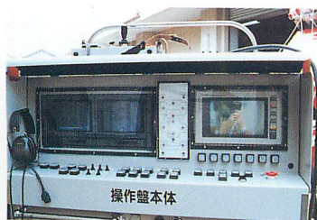
▲壁面昇降ロボットの操作盤。本体にセットされたカメラからの映像を見ながら操作する。
