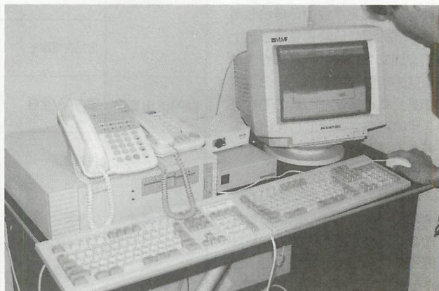
▲フレックス・ファウムの回線ビジネス用ハード、ノーブルIII。IBM-PCパソコンをベースに、インターフェース、ソフトに同社のノウハウを盛り込んでいる。
