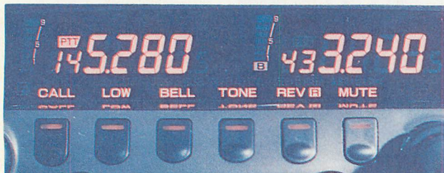
▲キーシフトはLCD内に表示された。ファンクションモードで機能変更すれば、それに合わせて表示も変わる。
