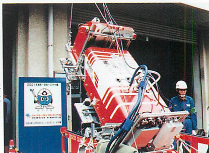
▲東京消防庁ご自慢の壁面昇降ロボット。といっても忍者のように自力で昇っていくのではなく、基本的にウインチで釣り下げて使われる。
