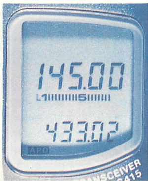
▲143MHz 帯以下ではオートでAM受信になるが、オートをオフにすることも可。その時は手動切換になる。
