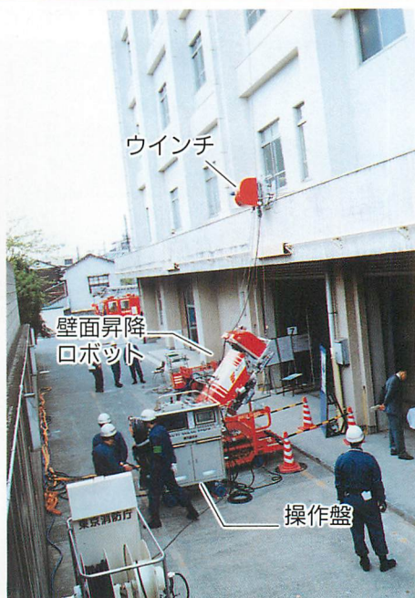
▲東京消防庁ご自慢の壁面昇降ロボット。といっても忍者のように自力で昇っていくのではなく、基本的にウインチで釣り下げて使われる。
