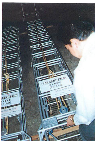
▲ハシゴだって進化している！写真は、アルミ合金を素材とした軽量なハシゴ。従来の約半分の重さ（25kg）を実現。現在、立川と蒲田署で使われている。
