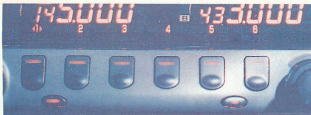
▲6つのプログラマブルメモリの呼出しは、横に並べられた6連キーが、それぞれに対応して、ワンタッチで呼び出せる。
