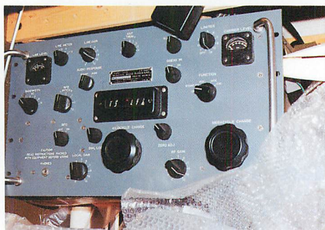
▲コリンズのR-390A。HF帯の受信機。メカニカル・デジタルで周波数表示します。
