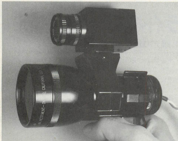
▲写真3 超コンパクトサイズに改造したマグライトに、専用のクランプ2個を使用して、CCDカメラとグリップを装着した。
