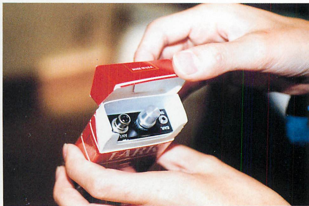
◀▲カバンに内蔵したピンホールカメラ。2mm程度の穴から撮影する。
