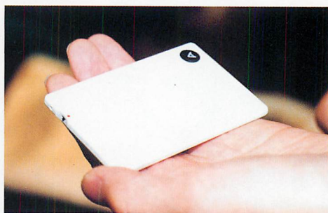
▲カード型のワイヤレストランスミッタ。胸に入れた財布に忍ばせておけば、証拠收拾にもなる。
