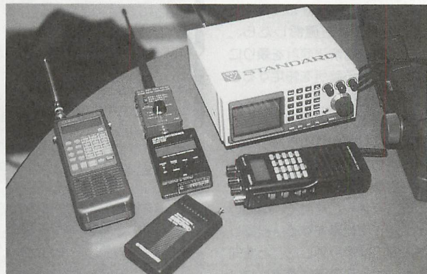
▲盗聴器探しの装備は基本的にレシーバー。簡易スペアナのあるA X 700 Bはプロに人気があるようだ。
