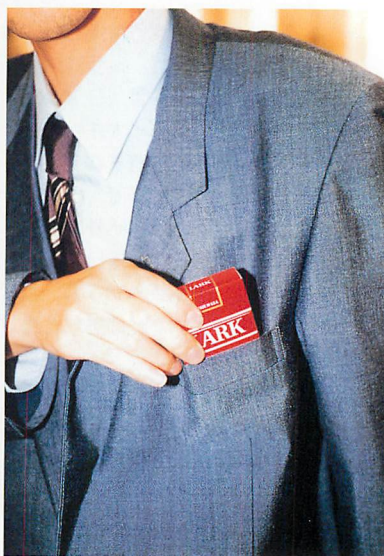
▲▼タバコの箱に内蔵されたトランシーバ。タバコを取るふりしながらP T Tスイッチを押せば、周りに気付かれずに交信できる。
