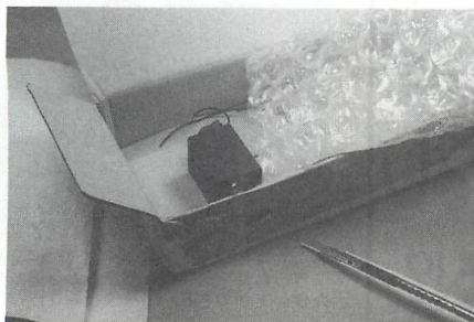
▲紙袋に入りそうな箱を用意し、CCDカメラをしっかりと固定する。
