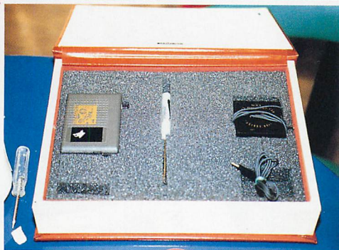
▲▼ポケベルに内蔵されたバイブレータ式盗聴発見機。近くに盗聴器があると、バイブレータで知らせてくれるという装置。価格は25万円。
