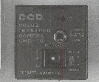
▲▶アールエフシステムのデュアルCCDカメラCMD-5Cは、マイクによる集音とトランスミッター機能を持っている!
