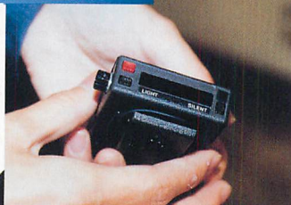
▲▼ポケベルに内蔵されたバイブレータ式盗聴発見機。近くに盗聴器があると、バイブレータで知らせてくれるという装置。価格は25万円。
