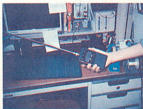
▲全長約50cmのロッドアンテナが付属しており、盗聴発見機としても活躍しそう。
