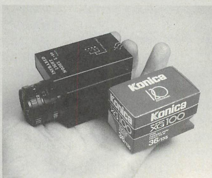
▲デュアルCCDカメラCDM-5Cと赤外線ライトL50をドッキングさせたところ。
