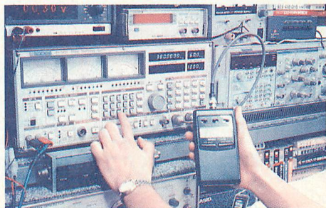
▲無線機テストを使用して感度特性を見てみたが、このクラスではなかなかの性能を持っている。
