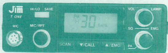
▲トヨムラから発売されたT-ONE。28MHz帯AM/FMトランシーバ。モバイルにもポータブルにも使え、ポータブルキット込みで19,800円という安さに信じられない思いをさせられた。
