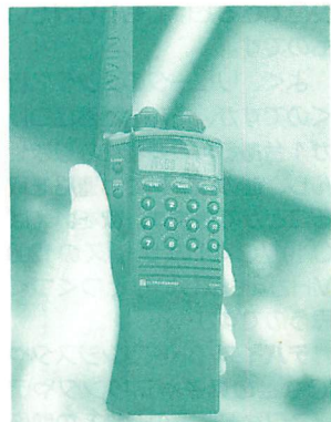
▲マランツが突然発表したC560は、144/430/1200MHz帯の3バンド対応で、大きさがモノバンド機並み。1200MHz帯は35mW。できれば100mW欲しいところ。
