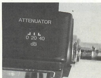
▲F S 7000の段階式アッテネータ。可変式アッテネータとの組合せで、必要だけ感度を落とす。
