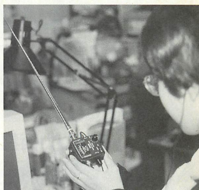
▲ホイップアンテナで盗聴器探索中…。アンテナを八木にすれば、もっと便利だ。
