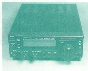
▲ケンウッドの50MHz帯オールモードトランシーバTS-60は、HF機に近い仕様だ。
