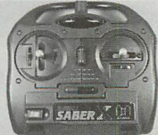
▲わかめのプロボ。サンワの2ch。27MHzAM。CBとの混信が心配なら40MHz帯のPCMプロボをおすすめ。
