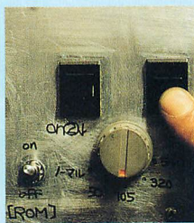
▲写真17 変造機のフロントパネルのスイッチ部分。変造ROMを切り替えるロータリースwitchと、書き込み動作をさせるためのスイッチがある。
