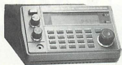
▲アンテナの調整にかかせないのがこのS WR計。送信機とアンテナの間に入れてインピーダンスのマッチングを測定する。
