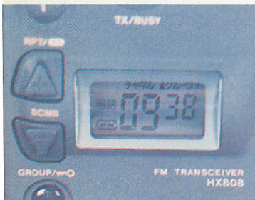
▲ディスプレイ部には夜光塗料が塗られ、暗いところでも、表示を見ることができる（照明下に10分置くと30分光る）。ただし、明るいところでの視認性はいまひとつ。
