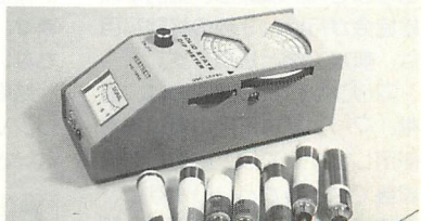
▲ディップメータ。共振周波数をチェックするのに使う。合わせたい周波数のコイル（ディップメータ専用）を付け、被測定物に近付けて測定する。ディップ点が測定器と被測定物の共振点が一致したことを示す。
