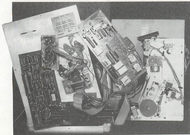
▼写真2 MC-2の内部をユニットをベースにしたテレカ変造機を分解したところ。カードリーダユニットや基板がそのまま流用されている。左側のアルミ板は変造機のフロントパネル。このパネルには、LEDの度数表示器まで取り付けられている。
