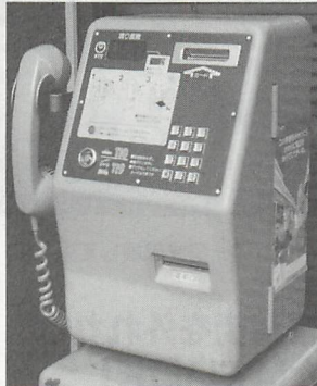
▲写真1 今回徹底解剖するテレカ変造機のベースとなったMC-2の同型機。カード型公衆電話の初期タイプで、カード専用のためコインユニットがないのが特徴。
