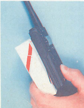
▲ディスプレイ部には夜光塗料が塗られ、暗いところでも、表示を見ることができる（照明下に10分置くと30分光る）。ただし、明るいところでの視認性はいまひとつ。
