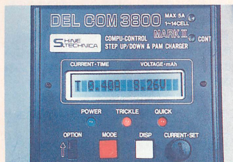
▲トリクル充電時。0.4Aが流れ、電池電圧は8.26V。
