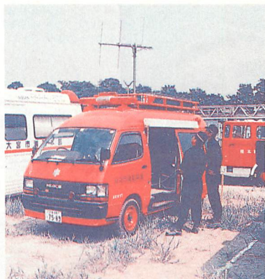
◀地元浦和市消防本部の浦和指令5。3エレメント八木を出して受信チェックをしているように見えた。反射エレメントはマストで代用しているためか下半分がありません。
