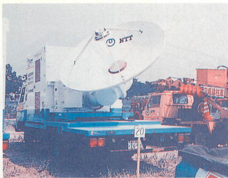
▲NTTは通信衛星回線使用の災害用非常電話システムを稼働させていました。隣は電柱建設用掘削トラック。
