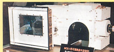
▲写真11 MOS-Iに搭載されている可視熱赤外放射計(VTIR)(富士通)。高度909kmから、99度×103分のエリアをスキャンしながら海洋・地表温度を計測する。
