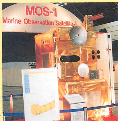
▶写真10 「ももI号」の熱試験用モデル(NEC製)。
