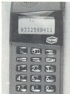
▲デジタル方式のツーカーセラー東京の電話は、県境にくると「ピーピー」と音が出るトラブルが発生した。
