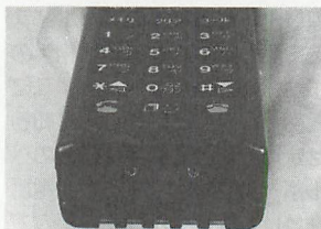
▲写真2 ムーバPの底面にあるコネクタのジャック部分。アンテナ用コネクタと電源・外部I/O（データ入出力）コネクタ。複合型の特種な形状。
