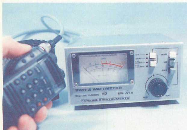
▲35mWというと、一般のパワーメータでは測定できないくらい微小だ。しかし、1200MHzリピータアクセスでは意外に健闘したぞ。
