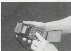
▲ツーカーデジタルの端末 T-H41。1.5GHz帯を用いる。デジタル機は秘匿性が高く、通話品質がよい、電池のもちがよいなどの利点がある。1.5GHz機は800MHz機にくらべてアンテナが短いのが特徴。
