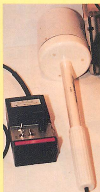
▲写真19 ポータブル仕様の電界・磁界強度測定器(narad)。周波数レンジは10~40MHzで、感度は200μW/cm 2 以上。上位シリーズでは、40GHzや0.01μW/cm 2 のものまである。
