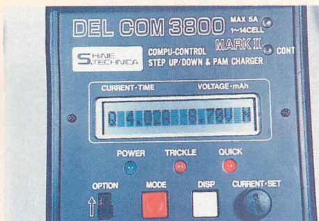
▲約4Aにて1400mAのバッテリーを急速充電開始。
