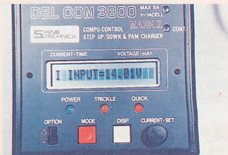
▲電源(車のバッテリーか5A以上の安定化電源)を接続したとき。電源電圧を表示。
