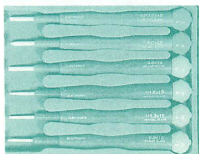
▲もし、コアを調整するときはセラミックドライバーを使うようにします。
