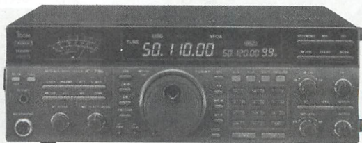
▲アマチュア無線短波用無線機をの内部配線をいじって中波で送信。
