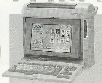
▲ハードディスク内蔵タイプの富士通のワープロ。パソコンとデータを共用するビジネス用として位置付けています。定価では同社のFM/Vが同一です。文書容量が1/3の分をプリンタ内蔵でカバーしているのか。
