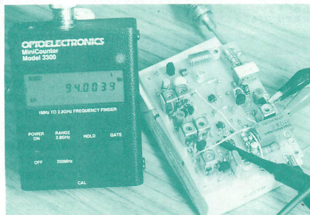
▲クリスタルの基本波(47MHz)を2連倍すると周波数は94MHzとなります。発振レベルの調整はオシロの方がやりやすいでしょう。
