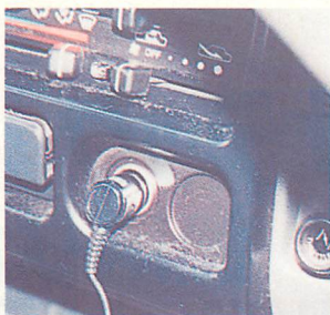
▲MS-300の電源は車のシガープラグから取る。
