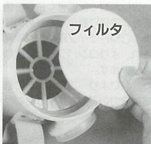
▲マスクの空気取り入れ口を見る。フィルタが1枚入っている。
