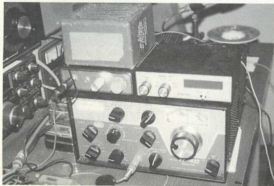
▲20年も前の受信機、ドレークのR-4C。しかし、1.9MHzでは最新型トランシーバで拾えない電波が取れるという。有坂さん現用機。
