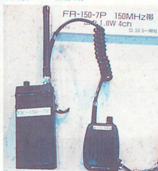
▼昭和36年から導入のFR-150-T車載型無線機、1波専用。
