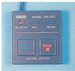
▲MS-300最大のウリが60秒間の録音機能だ。リモコンの「REC」ボタンを押すと録音される。音質は良い。通話していないときでも録音できるので、メモ代わりに使える。
