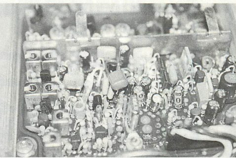
▲マイクアンプLPF部、改造中の様子。設定変更のためコードをいろいろ引き出している。
