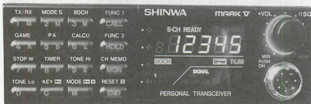
▲これが今回入手のパーソナル無線機の改造機。ベースとなっているのはシンワ通信機のSC905GV2。内部のコントロール用のROMが交換されている。また、秘話装置も内蔵済み。
