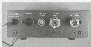
▲UHF帯のRF入力(EXTANT)にはN型 コネクタを使用。ANT. OUTは300～500 MHz帯を受信できる受信機へ接続する。
