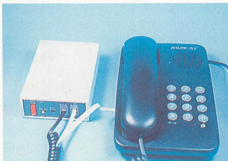
▲取り付けは、至って簡単。電話機本体と受話器の間に、専用小型モジュラーケーブルで接続するだけ。
