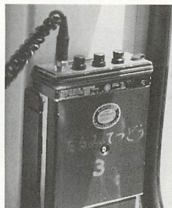
▲車両にはVHFのモバイル機が両端に設置されています。
