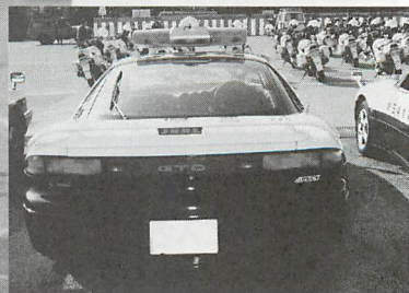
▼散光灯のスピーカー設置部分にレー ダーが付いている関係で、スピーカは前 部バンパーにセットされている。
