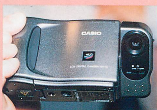
▲QV-10のレンズは、本体横に付いており、回転式。電源を入れている間は、カメラレンズが捕らえた映像を液晶画面に写しだされる。
