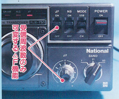
▲RJX-751では、受信周波数のみ可変する機能を \Delta F （デルタエフ）と呼ぶ。RITやクラフィファイヤと同じもの。
