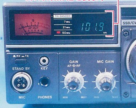
▲RJX-751の局部発振回路はPLL回路方式。周波数は電光管表示で100Hz台までが読める。写真は50.1019MHzを表示中だ。
