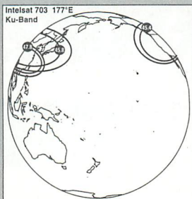
▲太平洋上のインテルサットは、アメリカ西海岸とアジア・太平洋を結ぶ。図内の数字の単位はdBW。
