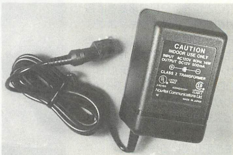
▲ACアダプタに表記されている電流値は、取り出せることのできる最大電流を表している。よって、使用する機器の消費電流よりも大きい値であればよい。
