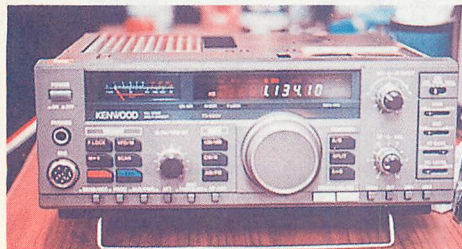
▲ケンウッドのHFトランシーバTS-680。Sメータの電球が切れているというだけで安く購入できた。
