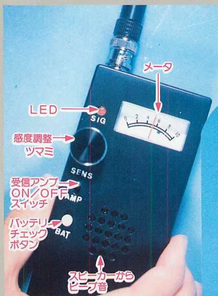
▲電波を感じると、メータが振れ「ブッブッ」という間歇音が早くなる。また、LEDの光も電波に応じて明るくなる。
