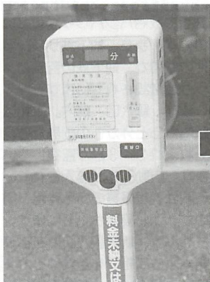
▲パーキングメータは超音波と赤外線利用のセンサで、車の存在を感知する。さっそくビデオカメラで覗くと…。
