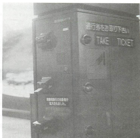
▲自動発券装置。運転席の高に合わせ、通行券券が発券される。この場所で同時に重量を測定するところもある。
