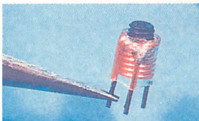
▲本機に使用するコイルは、 \phi 0.6\text{mm} のポリウレタン線などをコアに巻き付けて作ります。なお、このコイルはセンタータップを取ったものです。
