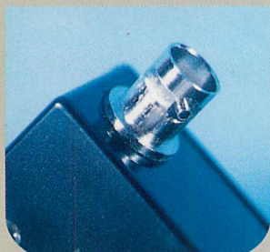
▲BNC端子を装備しているので、アンテナ交換やアッテネータの装備が可能だ。
