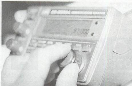
改造をすることで、受信することができるようになります。コードレスなら、144/430MHz帯無線機どちらでも受信できるようになります。800MHzを使用する電話の場合は、430MHz帯無線機でのみ可能です。
