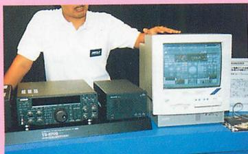
▲ケンウッドといえば、HF機! 新製品TS-870は、中間周波数の段階からDSP処理するデジタル機能満載の無線機だ。デモで、専用ソフトによるコンピュータ操作を披露していた。
