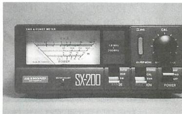
▲送信機とアンテナのインピーダンスマッチングをみるSWR計。1.5以下になるように調整する。
