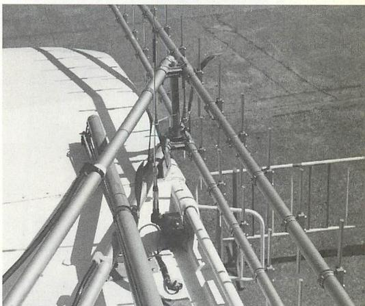
▲八木アンテナの影に隠れて、モバイルホイップアンテナが設置されていた。移動中のアンテナだ。基台はマルドルの電動の可倒基台。
