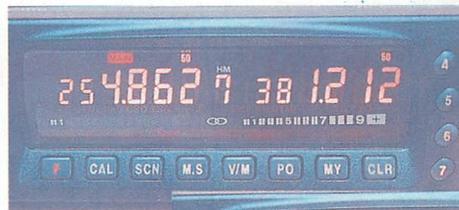
◀片方の選局ダイヤルを回すと、2局のVチャネルが同時に受波できる。周波数変換機能も搭載。受信機を受信機として使うこともできる。
