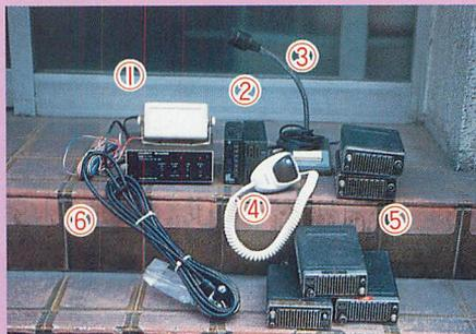
▲周波数担当編集部員の買物①センサーで感知する警報機。コードが長い②15V・3.3A電源と15V・1.6A電源③ナショナルのスタンドマイク・モデルEA-M1018④スタンダードブランドの旧型マイク⑤株ゼネラル製超短波無線電話装置昭和58年もの⑥車載用V/UHFマグネットアンテナ。
