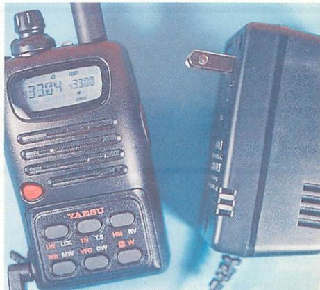
▲FT-40には付属で標準充電器が付く。なお、ニッカドバックを装着している状態で外部電源を取ると、自動的に充電される。
