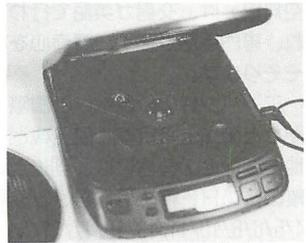
▲CDは連続した音を、不連続の2つの信号に変換して記録している。記録も再生もレーザー光で行う。
