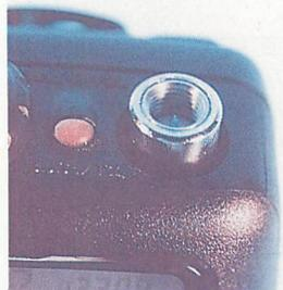
▲FT-40のアンテナはSMAコネクタ。ボディが大きめだからBNCでもよかったような気がするが…。
